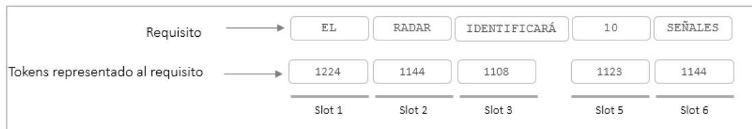
FIGURA 3-3 CONVERSIÓN DE UN REQUISITO EN TOKENS USANDO LA HERRAMIENTA KM
