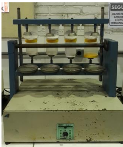
Figura 33. Misturador giratório empregado na preparação das amostras experimentais de escória.
