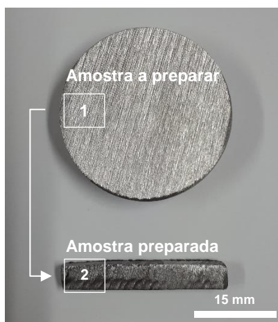
Figura 43. Amostra de aço para análise simultânea de oxigênio e nitrogênio.
