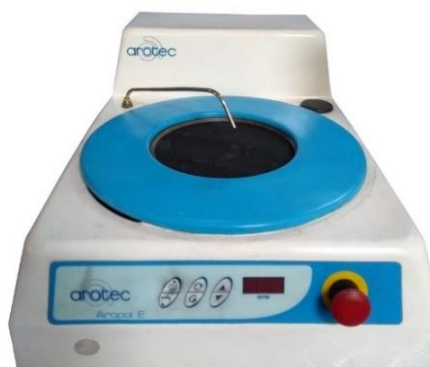
Figura 35. Politriz para preparo de amostras de aço após etapa experimental.
