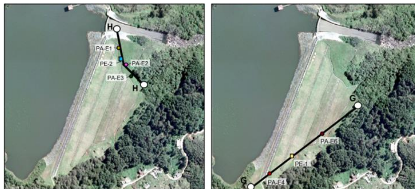
Figura 45.- Ubicación de PA's de los estribos
