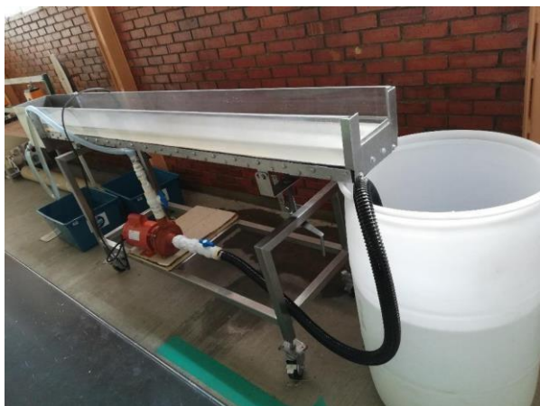
Figura 2. Canal de laboratorio de pendiente variable con electro-compuerta de acrílico, DICIVA-UG
