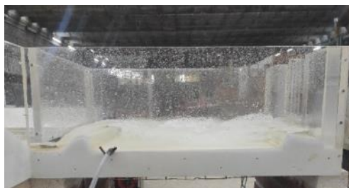
Figura 76.- Apertura total de compuertas. Cota embalse: 754.8 msnm. Q= 24.8 \text{ m}^3/\text{s} .
