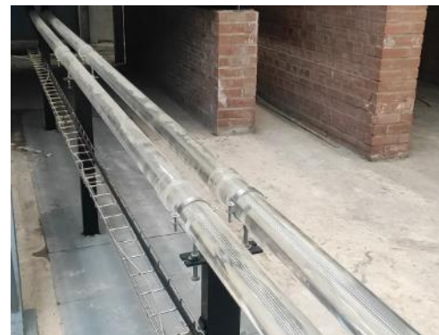
Figura 75.- Solución propuesta. Modelo físico. Funcionamiento a la cota 772 msnm, Q= 48 \text{ m}^3/\text{s} .
