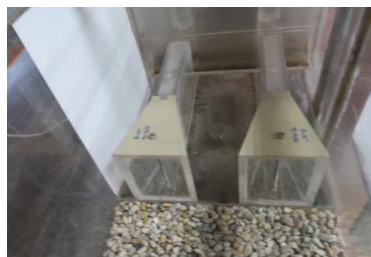
5.a) Pilares alargados acoplados ao órgão de descarga
