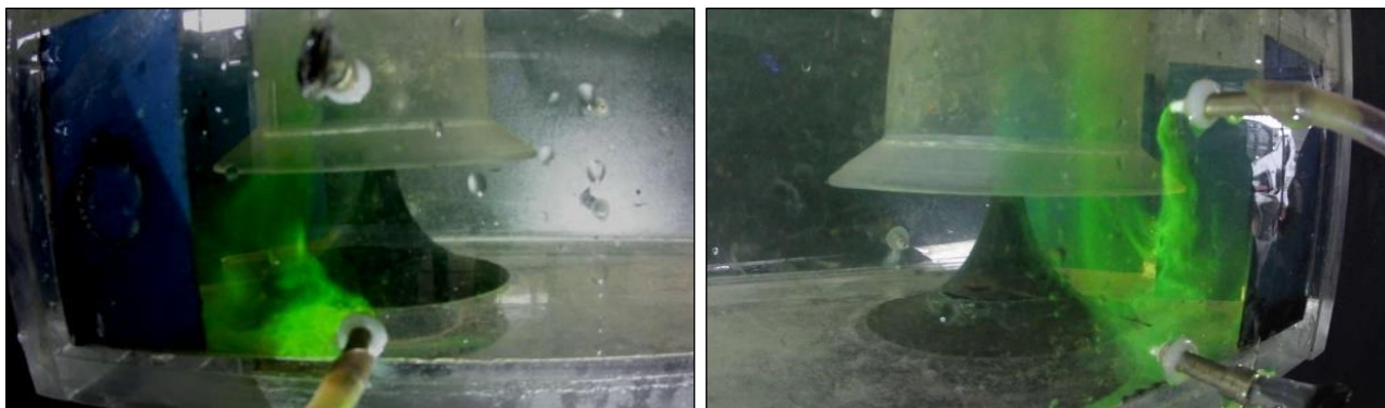
Figura 10.- Modelo físico (FdBP) - Q=27 \text{ m}^3/\text{s} – Vórtices débiles en la succión de una bomba
