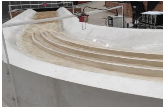
Figura 75.- Solución propuesta. Modelo físico. Funcionamiento a la cota 772 msnm, Q= 48 \text{ m}^3/\text{s} .
