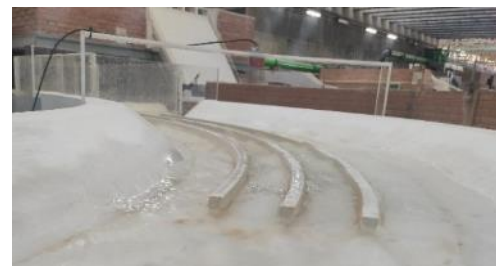
Figura 76.- Apertura total de compuertas. Cota embalse: 754.8 msnm. Q= 24.8 \text{ m}^3/\text{s} .
