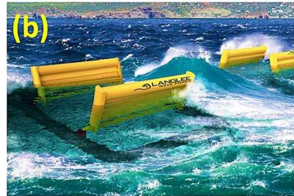
Figura 2.- Diferentes configurações de um OWSC: a – totalmente submerso, b – parcialmente submerso (National Renewable Energy Laboratory, 2021; Langlee Wave Power, 2013).
