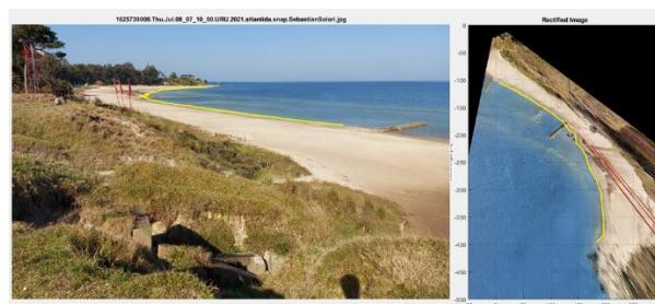
Figura 5.- Ejemplo de rectificación de imagen y detección de la línea de costa. Estación de monitoreo ciudadano en la playa Mansa de Atlántida, Canelones, Uruguay.
