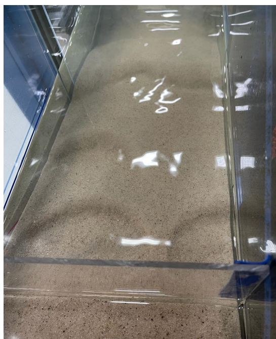
Figura 12.- Vista del perfil de equilibrio con estructura en posición “C” (vista desde arriba).
