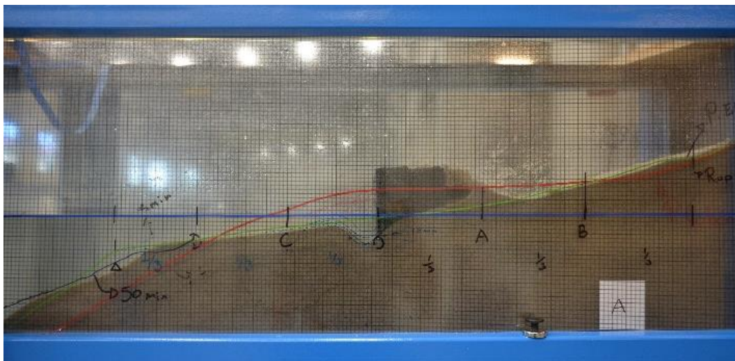
Figura 3.- Ejemplo ensayo de dique de cubos en la posición “O” al final del ensayo.
