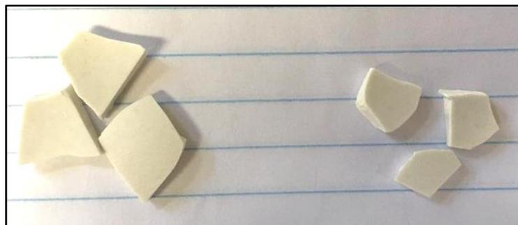
**Figura A2.2:** Fragmentos cerâmicos utilizados na etapa de contato enzimático no banho rotativo para auxiliar na agitação dos experimentos.
