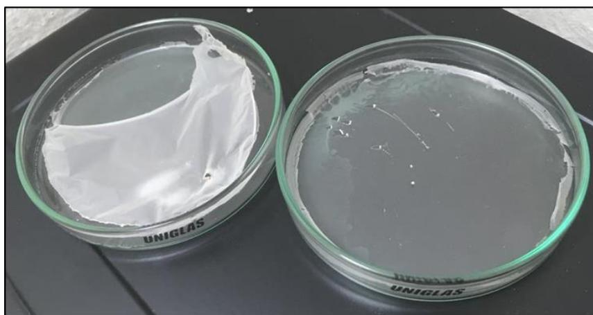
Figura 4.12 – Filme de biopolímero após extração com clorofórmio durante o processo de secagem.
