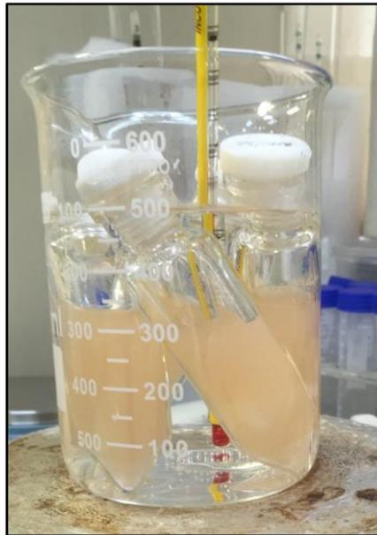
Figura 3.6: Experimento de extração com clorofórmio realizado à 60 °C por 180 e 360 minutos.
