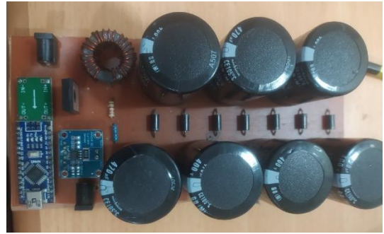
Gambar 10 Bentuk fisik multilevel boost converter
