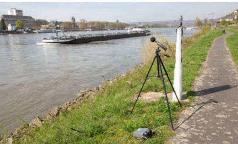
Abbildung 36: Messung der Geräuschemission eines vorbeifahrenden Binnenschiffs
