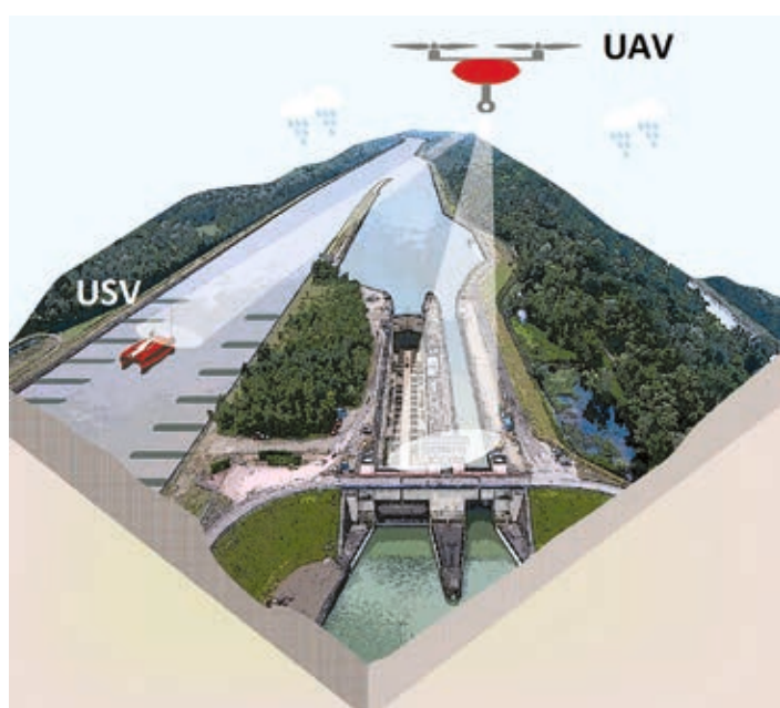
Abbildung 50: Gekoppeltes UAV/USV-Tandemsystem für die Wasserstraße (Quelle: RWTH Aachen)
