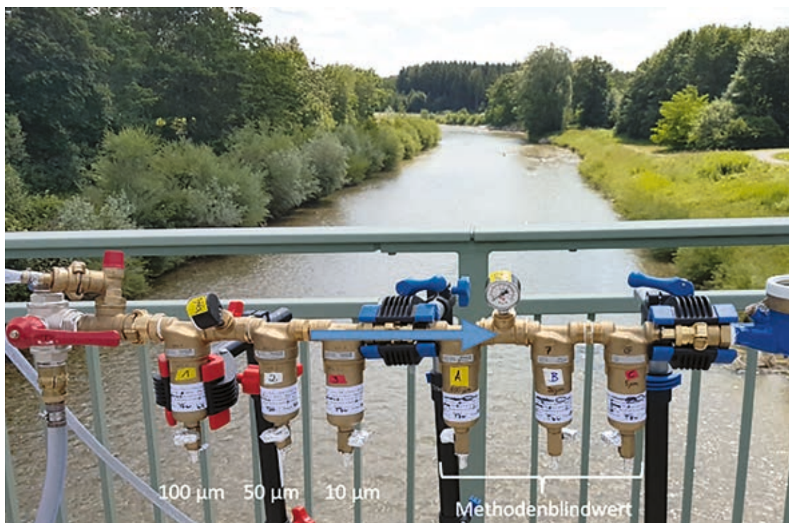
Abbildung 91: Größenfraktionierte Probenahme von Mikroplastik mittels einheitlicher Filterkaskade an der Amper (Oberbayern)
