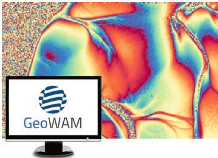
Abbildung 52: Ableitung von Digitalen Geländemodellen mittels flugzeuggestützter Radarinterferometrie
