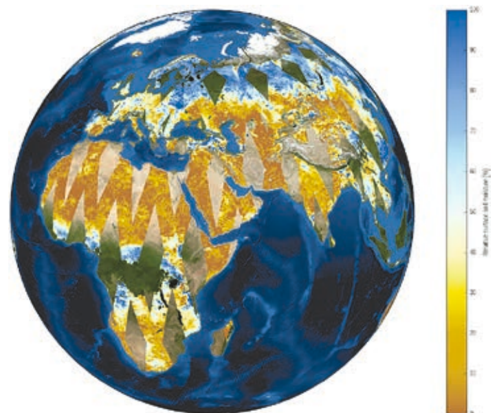
Abbildung 114: ASCAT-Daten (METOP-Satelliten, Bodenfeuchteprodukt H16, 22.05.2014) bilden die Grundlage für den globalen flächendeckenden Bodenfeuchtesättigungsindex SM-DAS2/H14 (täglich; 25 km Raster; vier Bodenschichten; Quelle: EUMETSAT H SAF )
