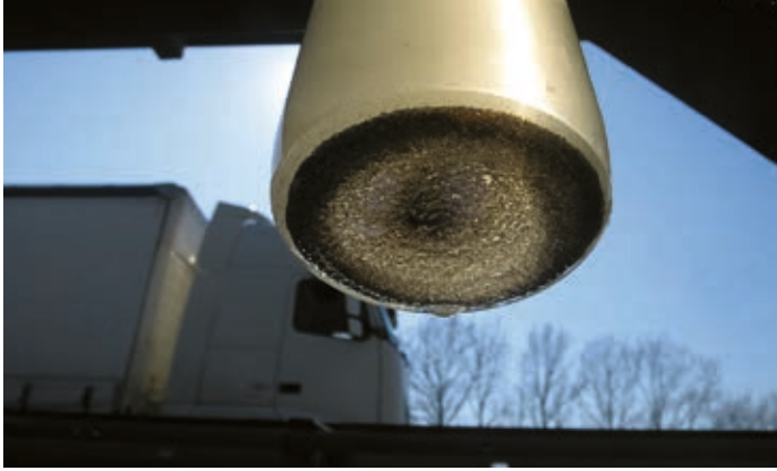
Abbildung 32: Abriebe aus dem Straßenverkehr in einer repräsentativen Abflussprobe einer Autobahn (90.000 Kfz/24h) (Sicht von unten auf die Probeflasche) (Quelle: Bundesanstalt für Straßenwesen)
