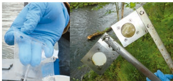
Abbildung 87: Typische im Projekt eingesetzte Passivsammler mit Silikonstreifen (links) und Chemcatchern (rechts)
