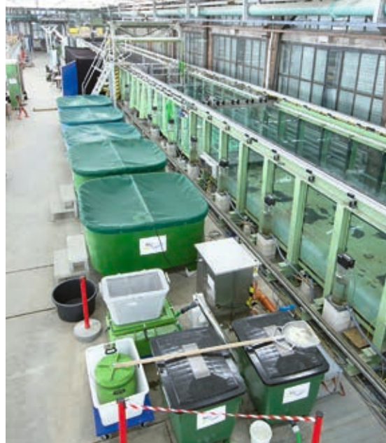
Abbildung 11: Ethohydraulische Versuchsrinne (rechts) und Hälterungsbereich für die Fische (Mitte) (Quelle: BAW)
