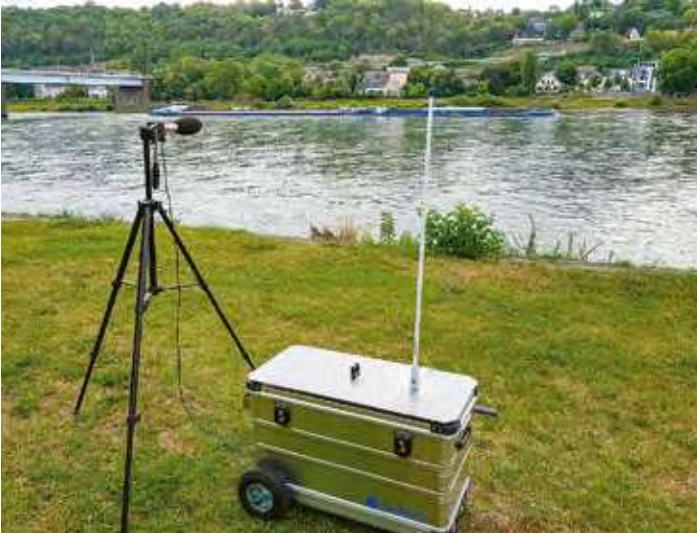
Abbildung 42: Messeinrichtung zur automatisierten Erfassung von Schiffsschall. © S. Sommer / BfG
