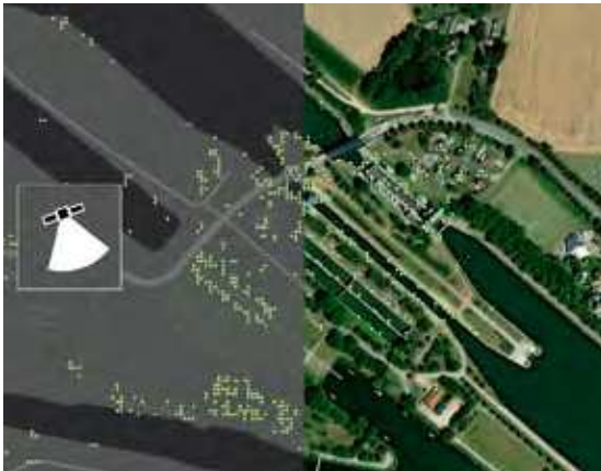
Abbildung 45: Überwachung einer Schleusenanlage mittels satellitengestützter Radarinterferometrie.
