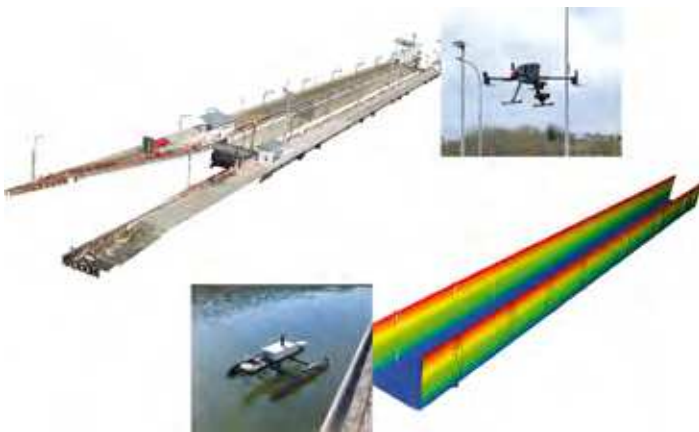
Abbildung 44: Flächenhafte Zustandserfassung mit unbemannten Messsystemen. © BfG (oben), Ocean Maps / BfG (unten)
