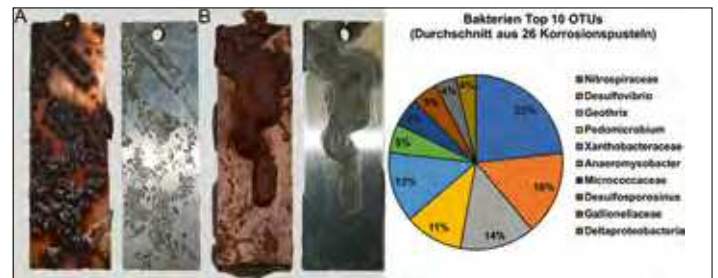
Abbildung 5: Stahlcoupons nach fünf Wochen Exposition in Rhein (A) und Mosel (B), Tortendiagramm der häufigsten Bakterienarten.
