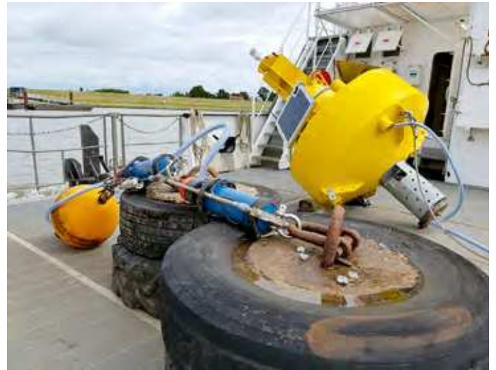
Abbildung 15: Mobiler Messstrang zur Erfassung von Strömung und Schwebstoffgehalten in der Unterems. © C. Borgsmüller / BfG
