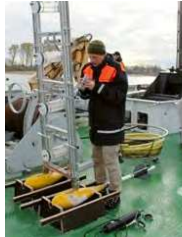
Abbildung 50: Montage des Messrahmens mit Van-Dorn-Flaschen zur Entnahme von Schwebstoffproben.
