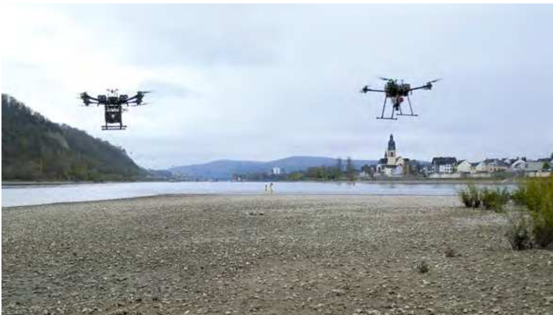
Abbildung 21: Luftgestützte Erfassung des Messgebietes mittels zweier Drohnen mit unterschiedlichen Messsystemen. © BfG
