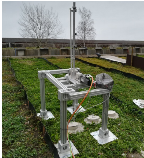
Abbildung 15: Auszugsversuche auf dem Außendeich.
