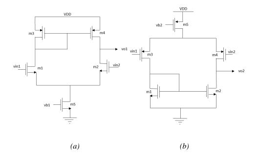
Figure 3.2 a) NMOS input OTA b) PMOS input OTA
