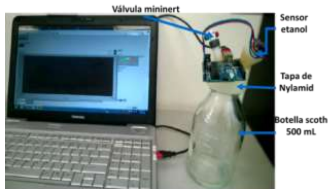
Figura 4. Sensor de etanol fase gas adaptado en tapa de Nylamid con válvula mininert.
