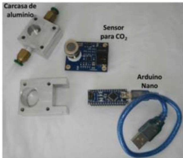
Figura 2. Imagen del sensor electroquímico para detección de CO 2 con carcasa de aluminio.
