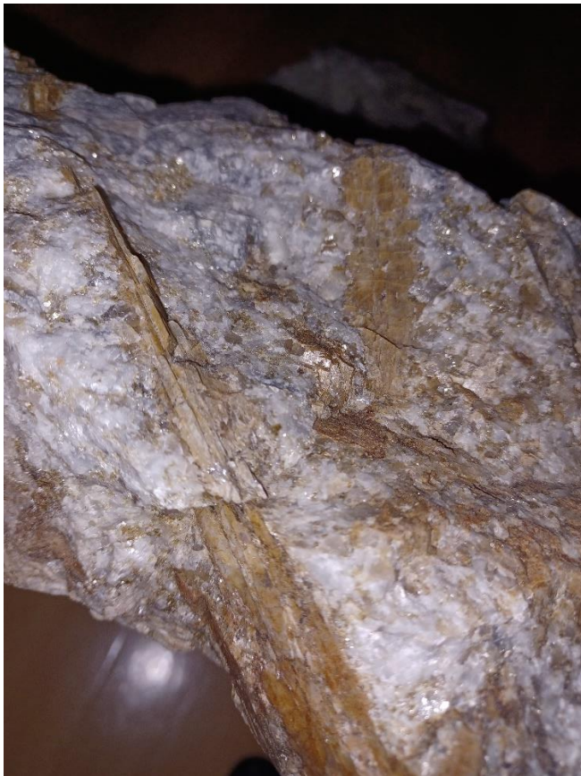
Kuva 5: Vihertävän haaleaa Spodumeenia Kaustisen Syväjärveltä. Kiteet ovat n 40–80 mm pitkiä ja 15 mm leveitä.
