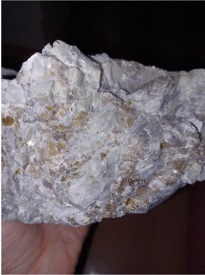
Kuva 5: Vihertävän haaleaa Spodumeenia Kaustisen Syväjärveltä. Kiteet ovat n 40–80 mm pitkiä ja 15 mm leveitä.
