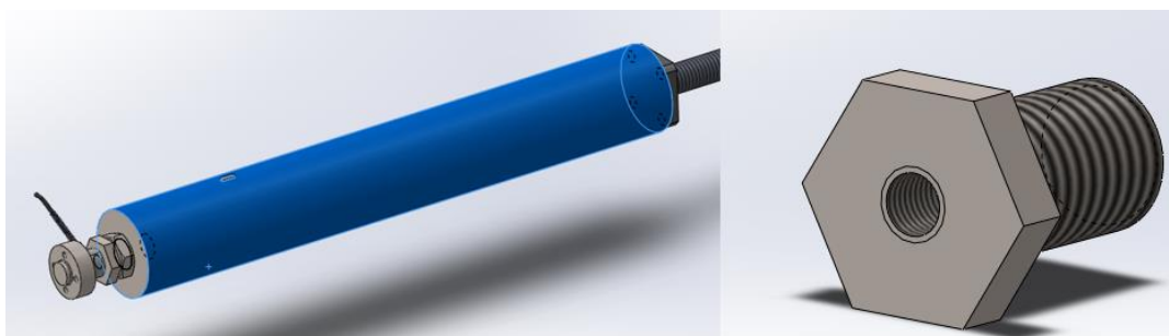
Figura 46 – À esquerda ligação da célula de carga ao tubo integrante; À direita peça adaptadora da célula de carga (b)
