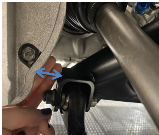
Figura 43 - Primeira opção de colocação do sensor entre as setas azuis.
