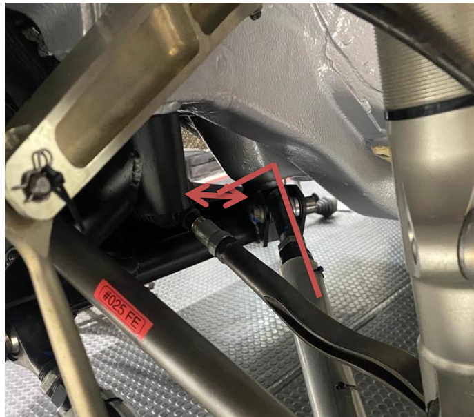
Figura 44 - Segunda opção de colocação do sensor entre as setas vermelhas.
