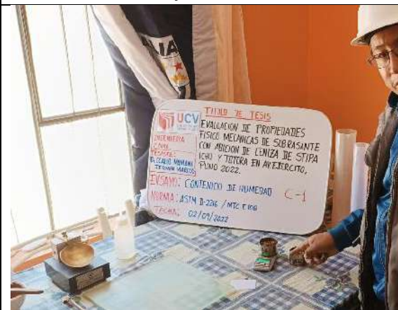
Imagen 42: Se anota el peso húmedo de la C-1 para contenido de humedad.
