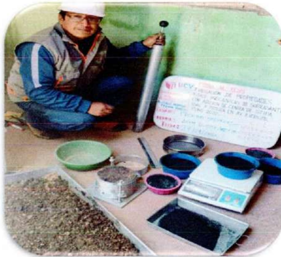
PANEL 19: EJECUCION DE PROCTOR CON ADICION C-1
