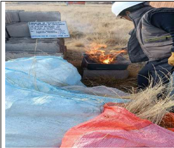
Imagen 22: Obtención de ceniza de stipa ichu
