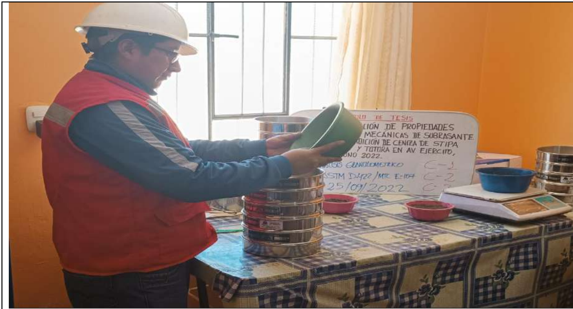
Imagen 71: Análisis granulométrico con adición de ceniza de ambos productos al agregado fino.
