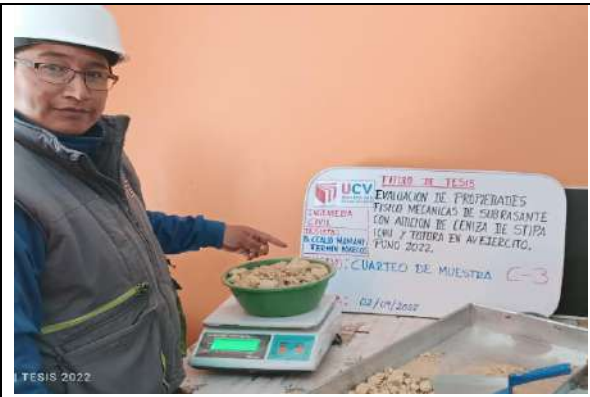
Imagen 51: Pesado de muestra para ensayo (análisis granulométrico) C-3.
