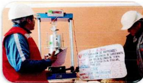
PANEL 18: EJECUCION DE CBR
