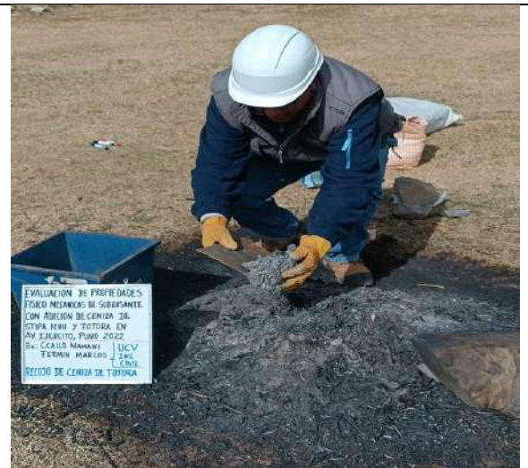
Imagen 15: Obtención de ceniza de totora
