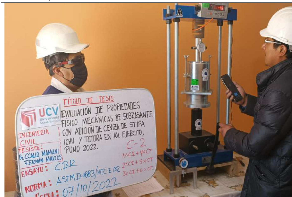
Imagen 76: Ensayo CBR para la C-2 con adición de ambos productos según dosificación planteado.
