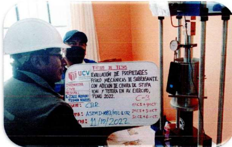
PANEL 24: EJECUCION DE CBR CON ADICION C-3
