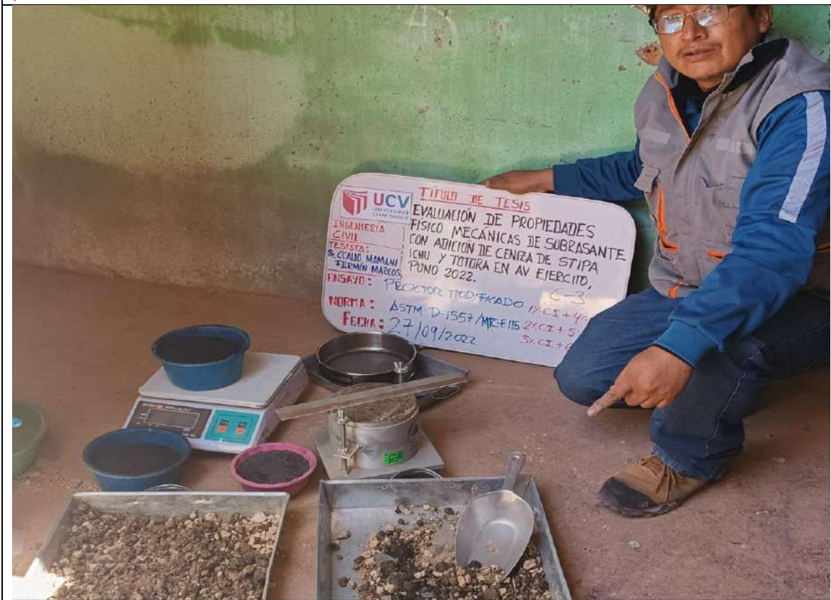
Imagen 74: ensayo Proctor modificado para C-3 con adición de ambos productos de ceniza.
