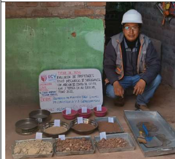
Imagen 52: Preparado de material para ensayo de granulometría y ensayo de límites de consistencia (C-1, C-2, C-3).
