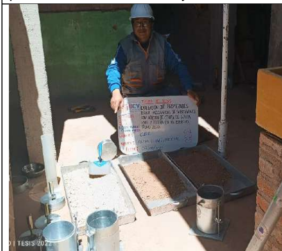
Imagen 66: Material para ensayo CBR.
