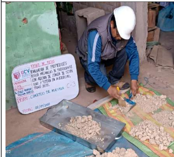
Imagen 48: Se cuartea el material C-3
