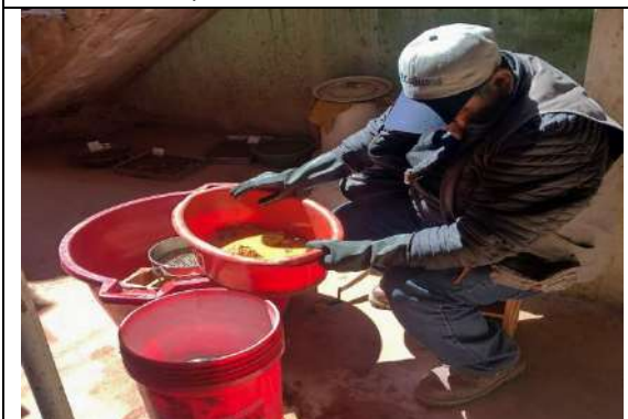
Imagen 54: Lavado de muestras para el ensayo de análisis granulométrico (C-1, C-2, C-3).
