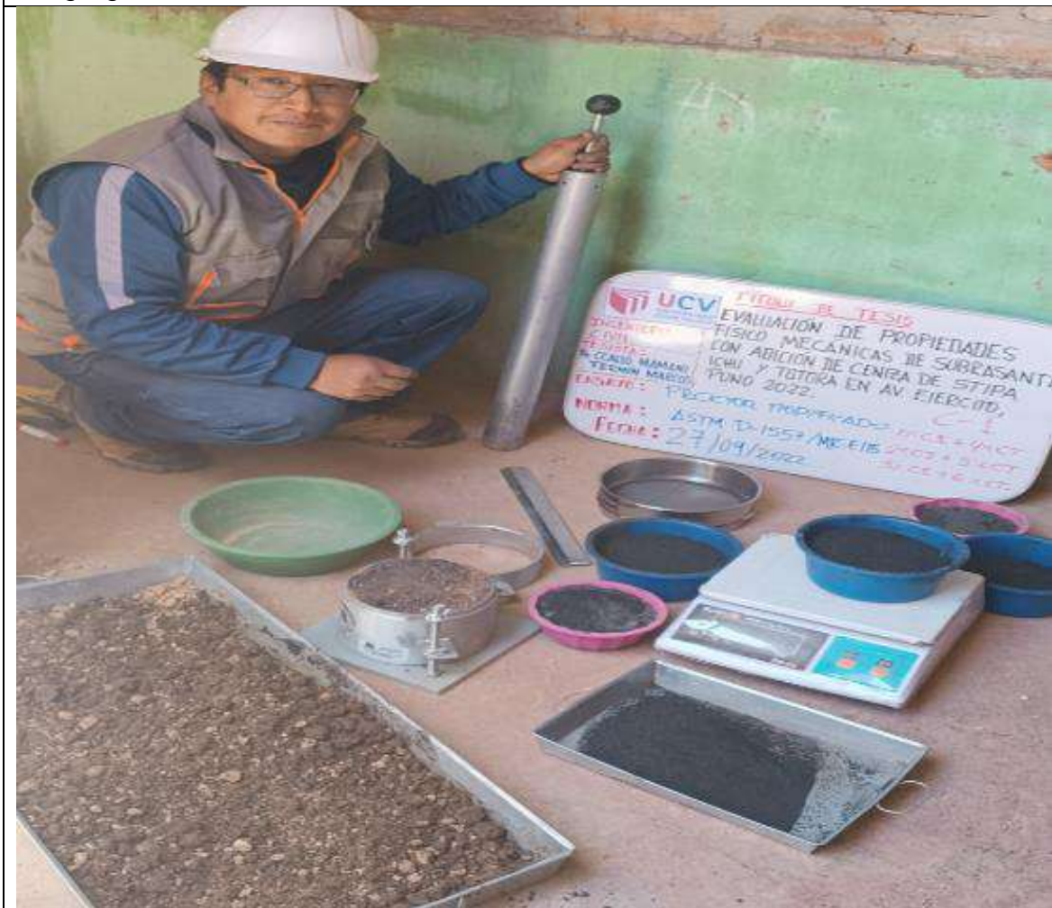
Imagen 72: ensayo Proctor modificado para C-1 con adición de ambos productos de ceniza.
