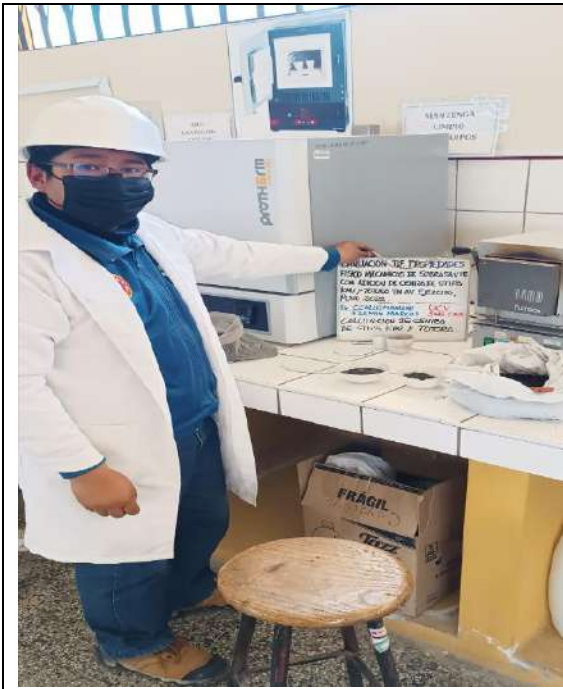
Imagen 28: Se calienta la mufla para introducir las muestras para la activación de ambas cenizas
