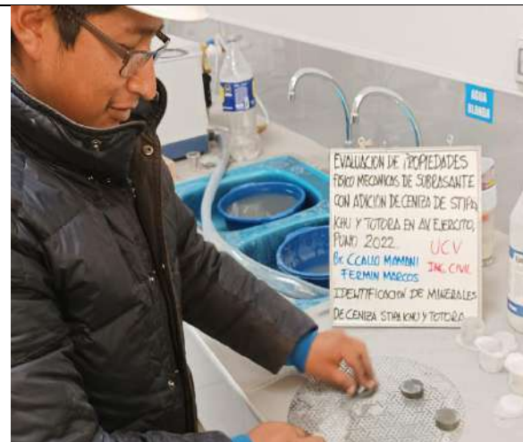
Imagen 37: Se realiza el lijado de las muestras circulares.
