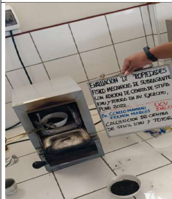
Imagen 30: Obtención de muestras de ceniza activada para el enfriamiento de la ceniza tanto stipa ichu y ceniza de totora.
