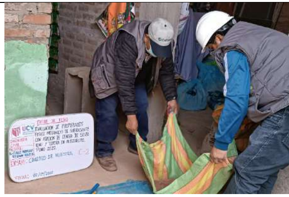
Imagen 47: Se cuartea el material C-2
