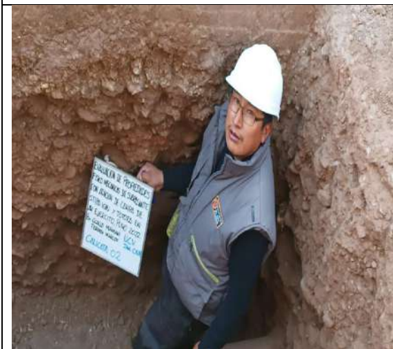
Imagen 05: Sondeo de la calicata N°2
