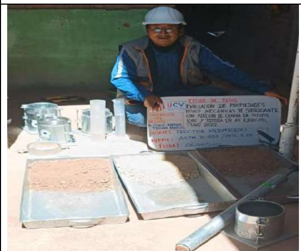
Imagen 65: Material para ensayo Proctor modificado.
