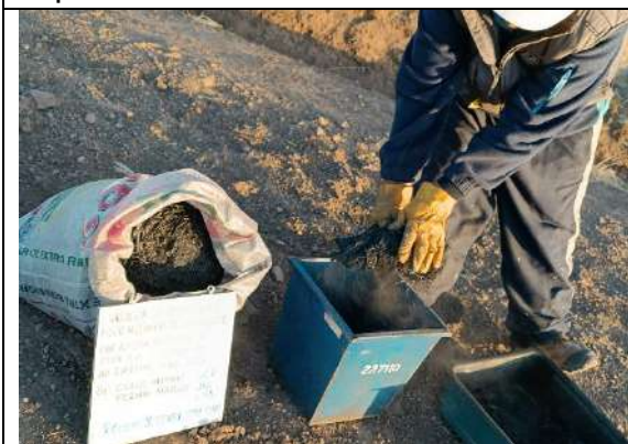
Imagen 26: Obtención de ceniza de stipa ichu
