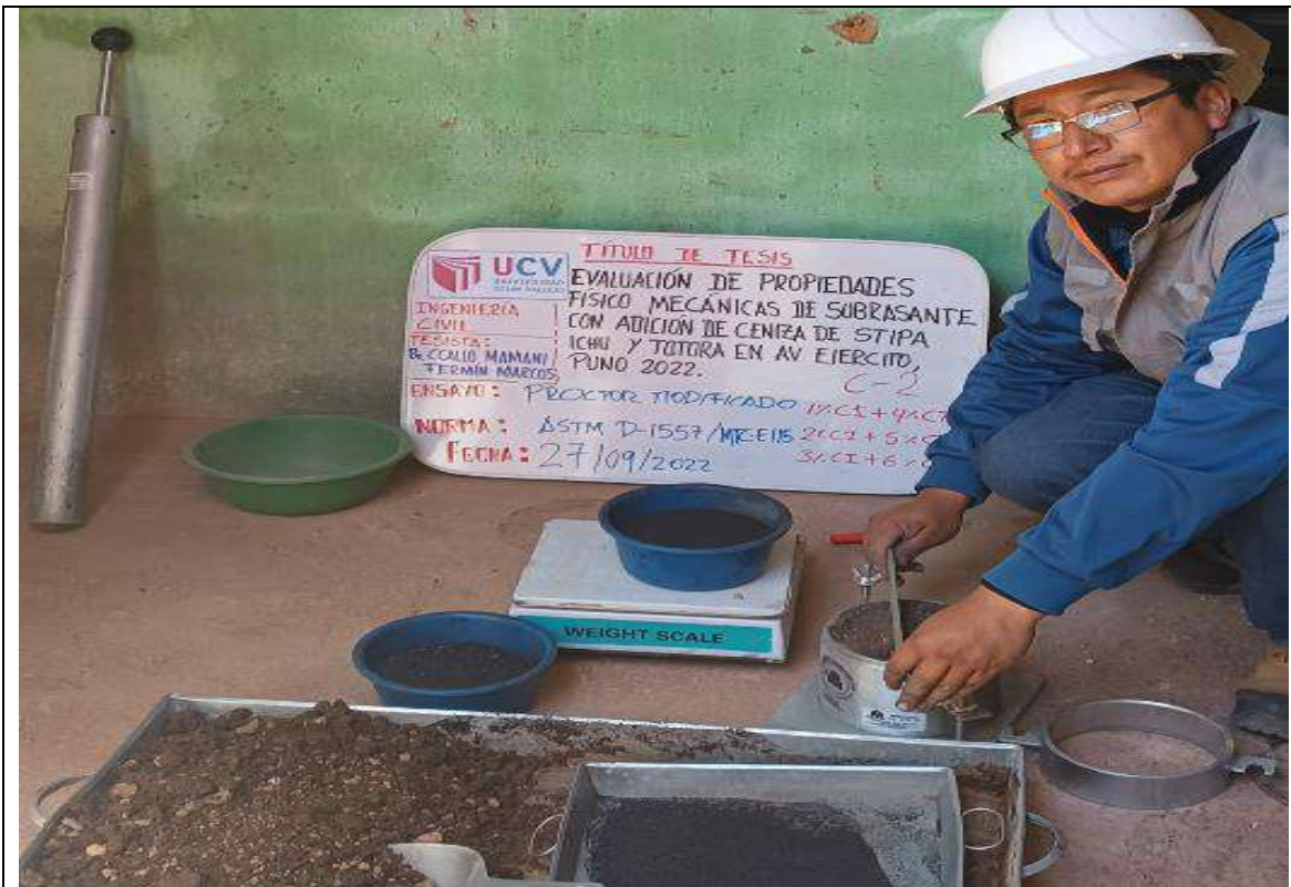
Imagen 73: ensayo Proctor modificado para C-2 con adición de ambos productos de ceniza.
