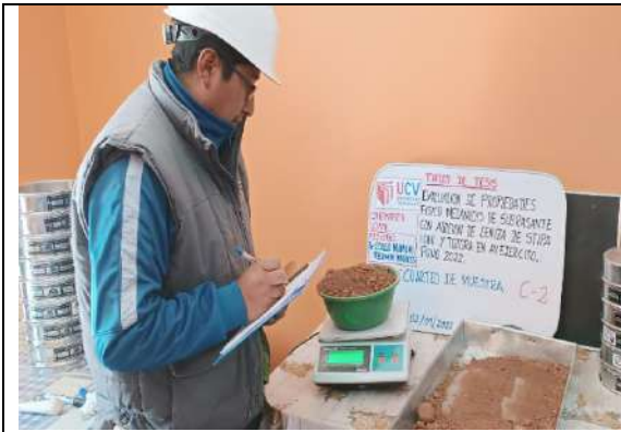
Imagen 50: Pesado de muestra para ensayo (análisis granulométrico) C-2.
