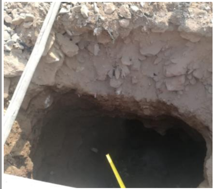
MUESTREO: Toma de muestras en calicata C-2 y determinación del perfil estratigráfico.
