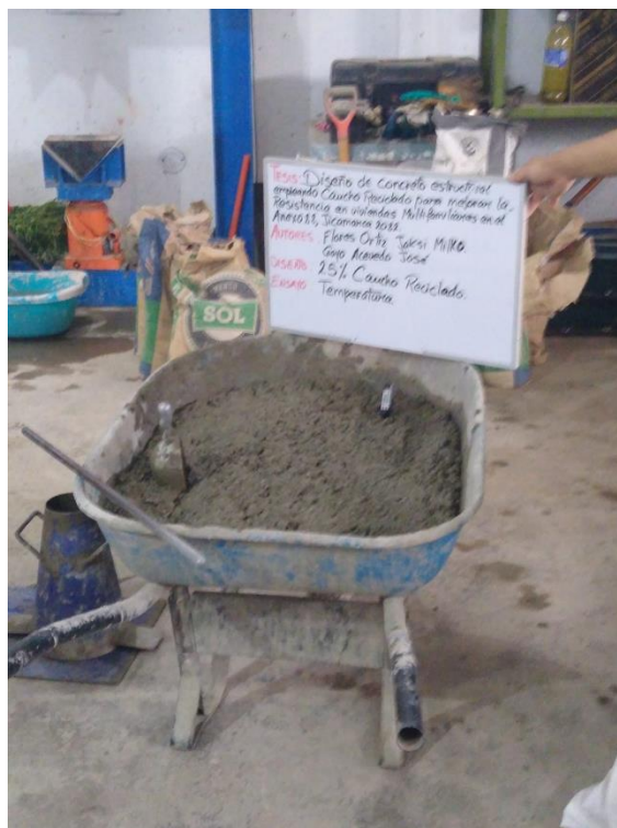
Figura 27. Ensayo de temperatura para concreto con 2.5% de caucho como aditivo.
