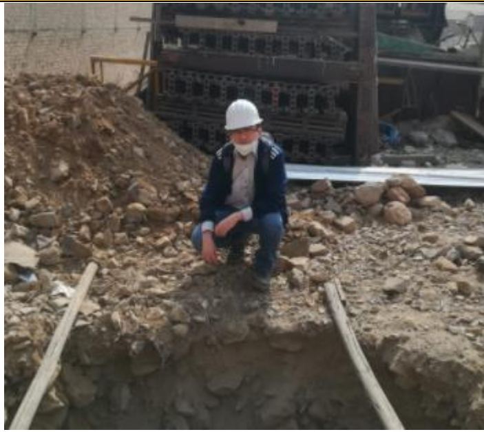
MUESTREO: Toma de muestras en calicata C-2 y determinación del perfil estratigráfico.
