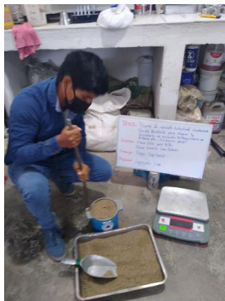
Figura 18. Peso Unitario de agregado fino.
