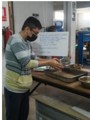
Figura 17. Análisis granulométrico de agregado fino
