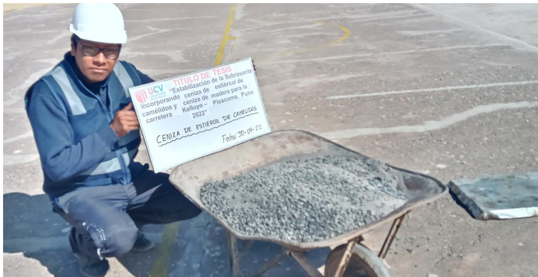
Figura 22. Obtención de la ceniza de estiércol de camélidos
