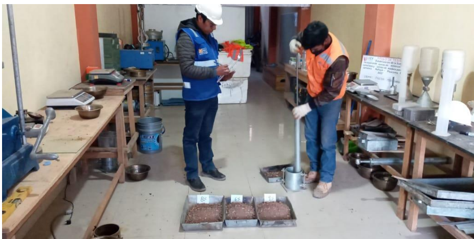
Figura 39. Ensayo de proctor modificado.
