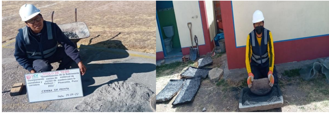
Figura 21. Calcinación de estiércol de camélidos y control de temperatura
