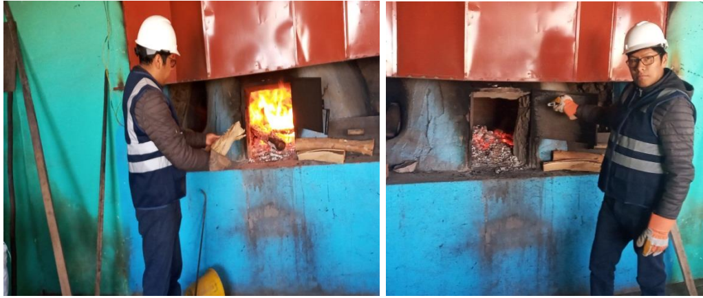
Figura 19. Calcinación de la madera y control de temperatura.
