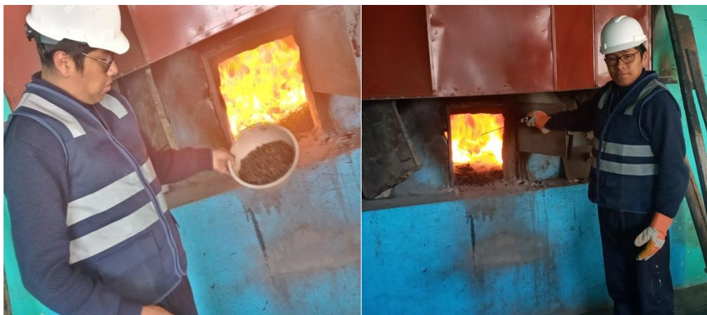
Figura 20. Calcinación de estiércol de camélidos y control de temperatura
