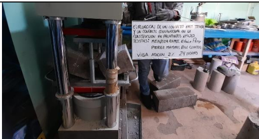
Figura 5. Rotura viga adición de 2% curado 24 horas.
