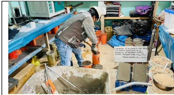
Figura 5. Elaboración de probetas de concreto.
