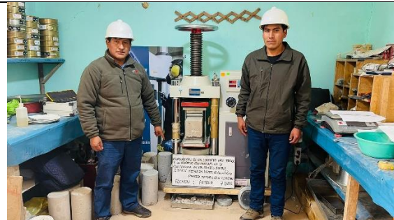
Figura 5. Rotura patrón curado 7 días.
