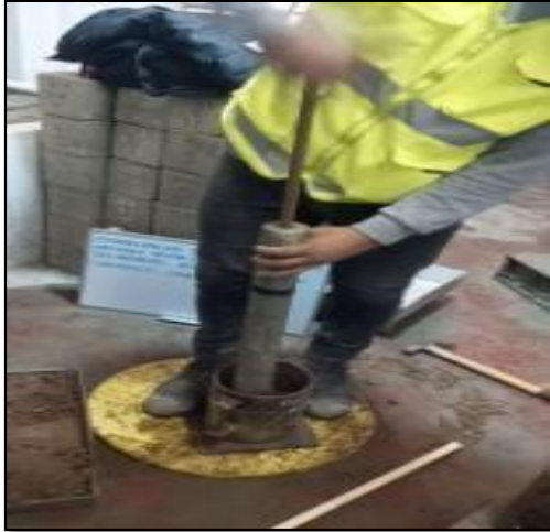
Figura 14. Compactación de capas
