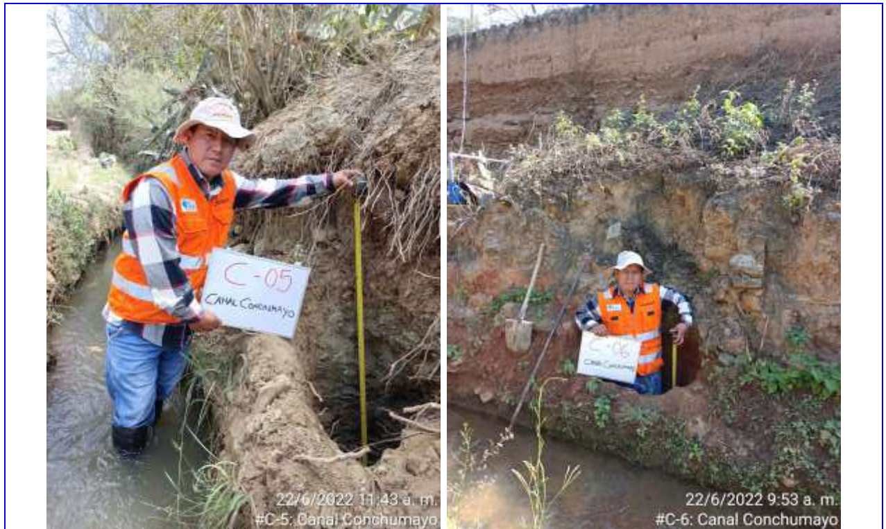
Foto N° 09: En las imágenes tanto izquierda como derecha se observan las calicatas 5 y 6 tomados en el canal.
