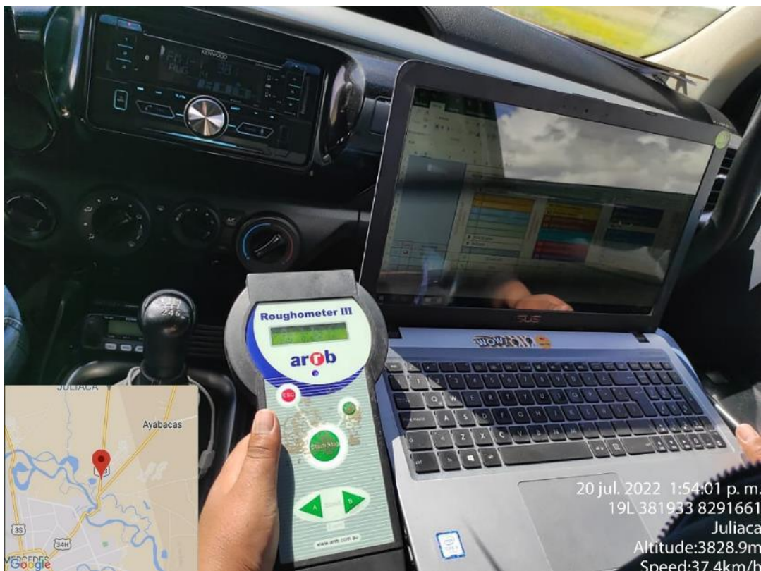
Figura N° 47: Toma de datos con el equipo de Rugosímetro III – IN SITU Fuente: Elaboración nuestra
