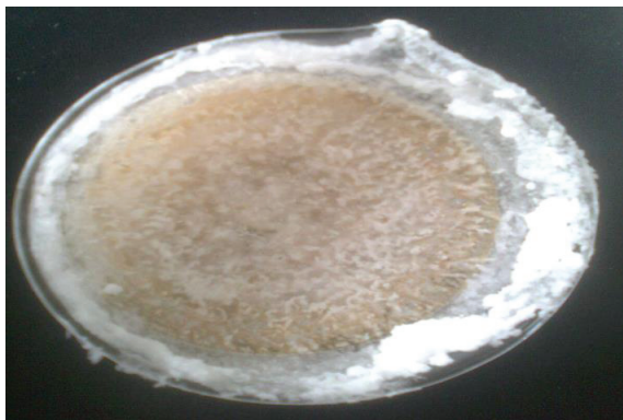
Rycina 46. Wytrącone sole z solanki z Geotermii Stargard (fot. B. Igliński)
