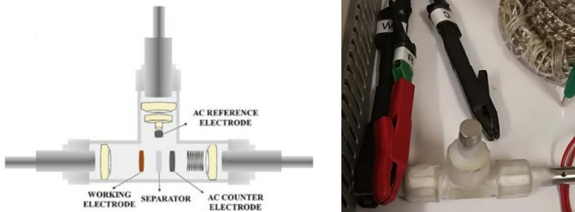
Figura 3.5.3 Esquema de la configuración de una celda tipo Swagelok de tres electrodos (izquierda) [35] y vista frontal de una celda montada (derecha).
