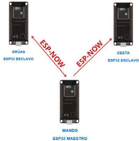
Figura 4: Esquema de comunicación.
