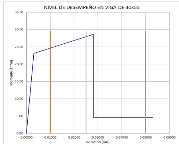
Figura 6: Rotula plástica en viga de 30x55 con su nivel de desempeño.
