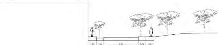
Se puede adecuar ampliando la calle, si se añade 2.5 m de la parte agrícola para el arbolado (Tipo: Calle tipo)
