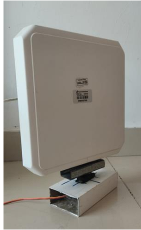
Fig. 4. Antena RFID UHF utilizada en la investigación
