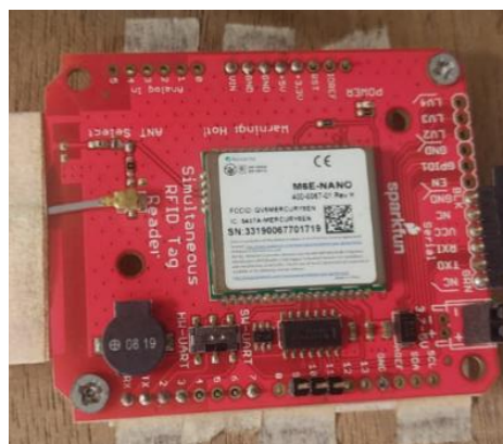
Fig. 2. Lector RFID UHF utilizado en los experimentos
