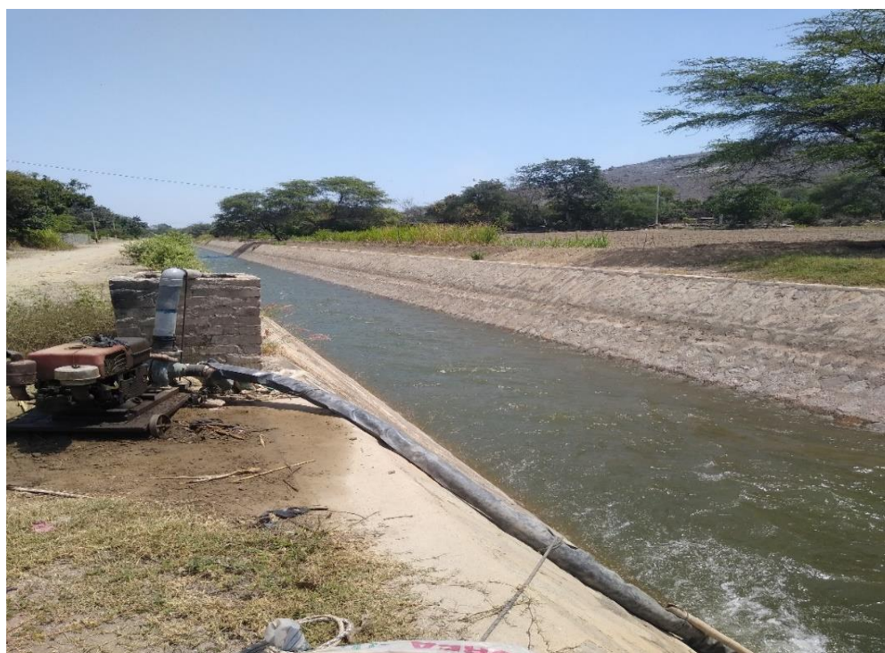
Figura N°1: Uso de motor petrolero para irrigar los cultivos cercanos al Canal Taymi del Distrito de Pátapo
