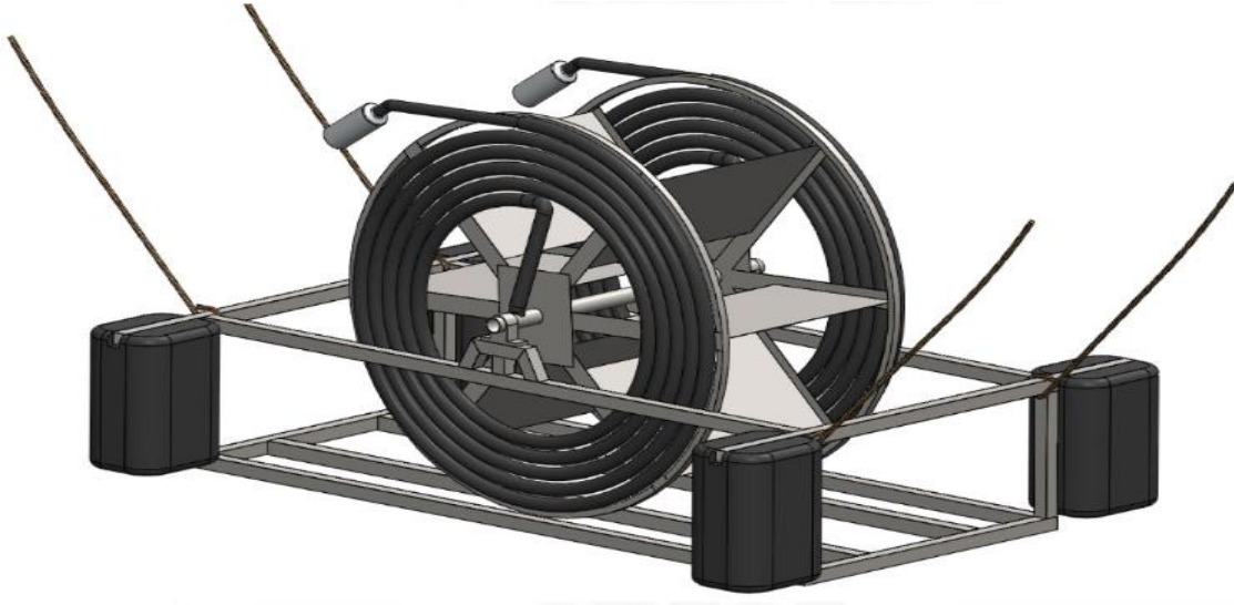
Figura N°22: Cuerdas que sujetaran la Bomba Barsha.
