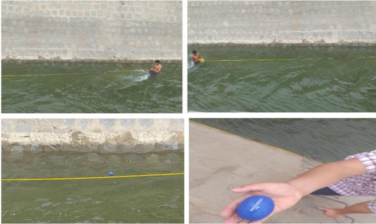
Figura N°5: Fotografías de los puntos y del flotador en el canal.
