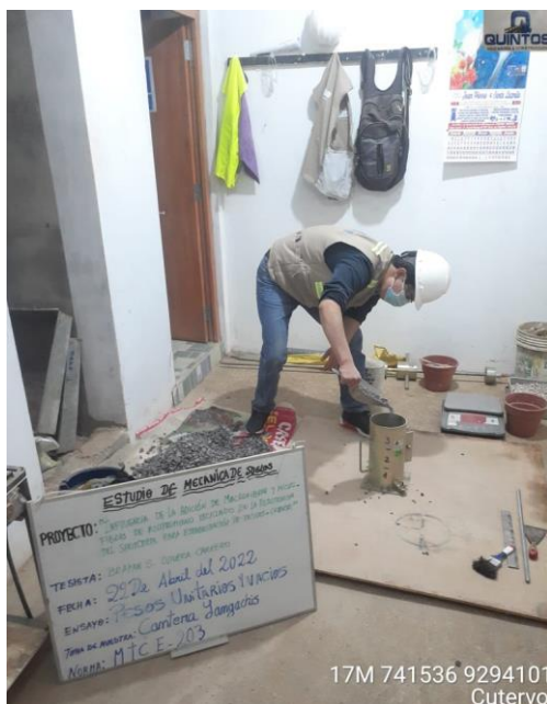
anexo 9: Vaciado de Agregado Fino y Grueso. Fuente: Propia
