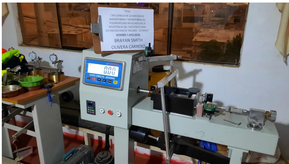
anexo 17: Máquina empleada en Corte Directo en Muestra de Suelo de Talud. Fuente: Propia
