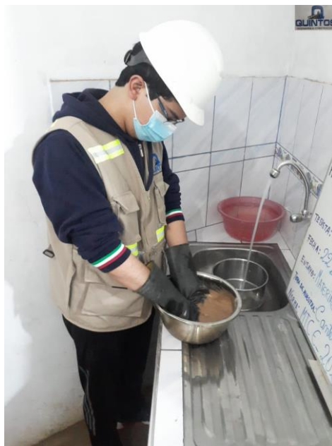
anexo 7: Lavado de Agregado Fino que pasa por tamiz N° 200. Fuente: Propia
