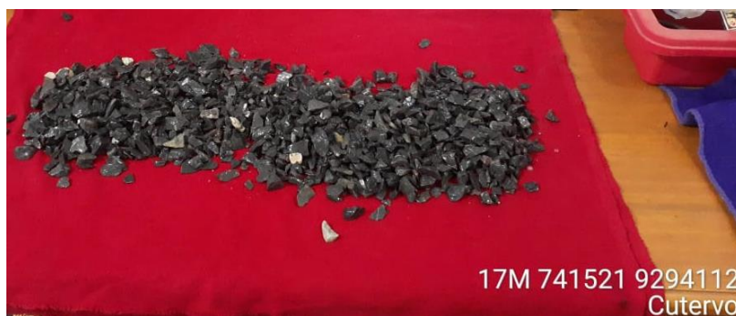
anexo 12: Lavado de Agregado. Ensayo De Gravedad Específica Y Absorción De Agregado Grueso. Fuente: Propia
