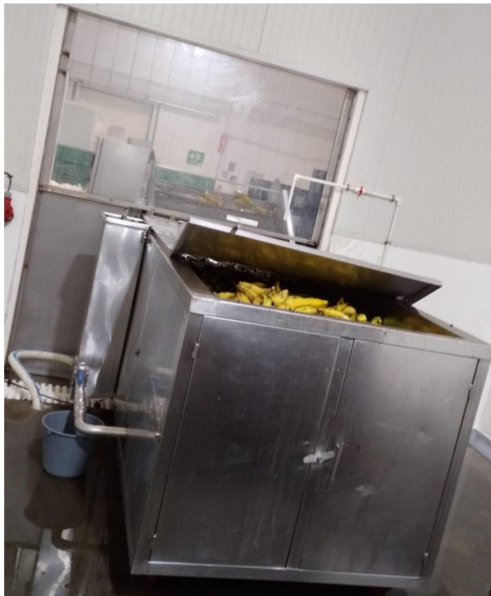
Entrada de plátano y proceso de desinfección.
