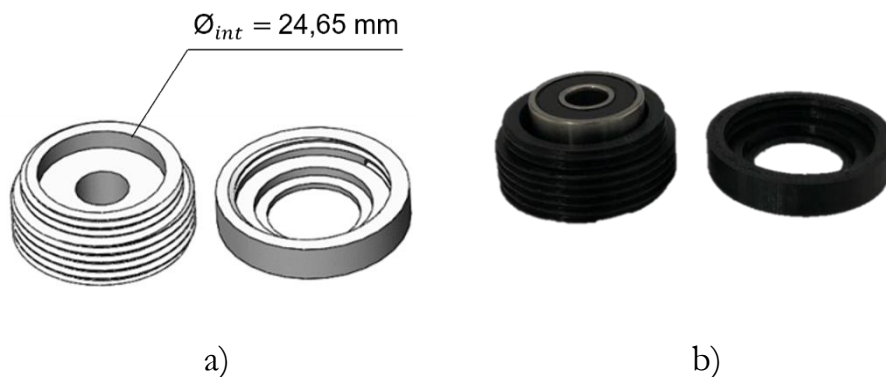
Figura 30 - Sistema do rolamento: a) modelo 3D; b) modelo real.
