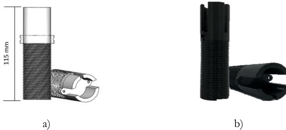
Figura 26 - Elemento lateral adaptado à célula de carga FC22: a) modelo 3D e b) modelo real.
