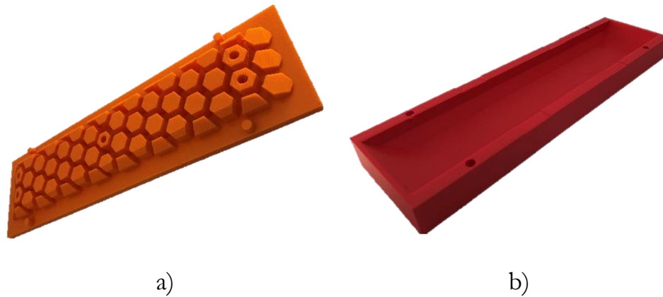
Figura 52 - Molde: a) Bucha; b) Cavidade.
