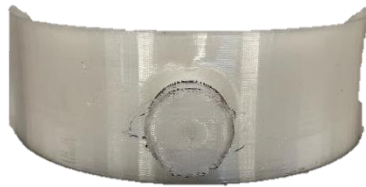
Figura 27 - Garra adaptada à célula de carga FC22.
