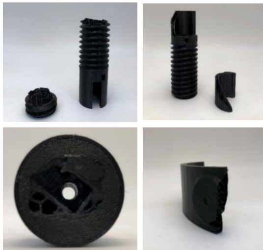
Figura 20 – Componentes com dano estrutural.
