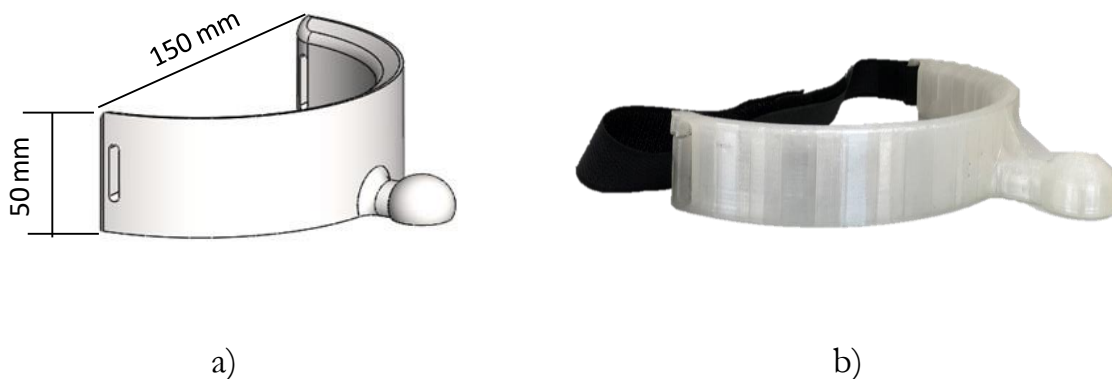
Figura 24 - Garras (1ª versão) a) modelo 3D e b) modelo real.
