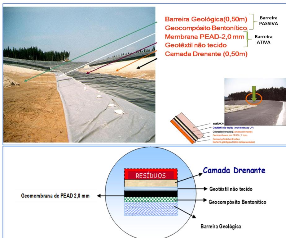
Figura 2. 12 -Sistema de impermeabilização basal do aterro (Levy e Cabeças, 2006).
