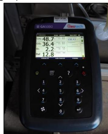
Figura 3. 29 - Aparelho (GA 5000) utilizado para realizar medições do biogás. (Foto do autor)
