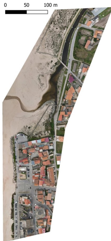
Figure 18 – Own survey (DTM – Agisoft), pixel size: 0,042x0,042m
