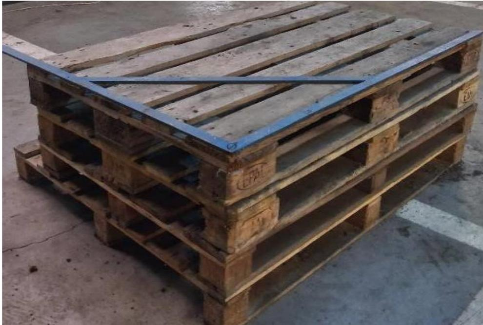
**Figura 10** – Plataforma e esquadro referência, onde se efectuaram as fotogrametrias.
