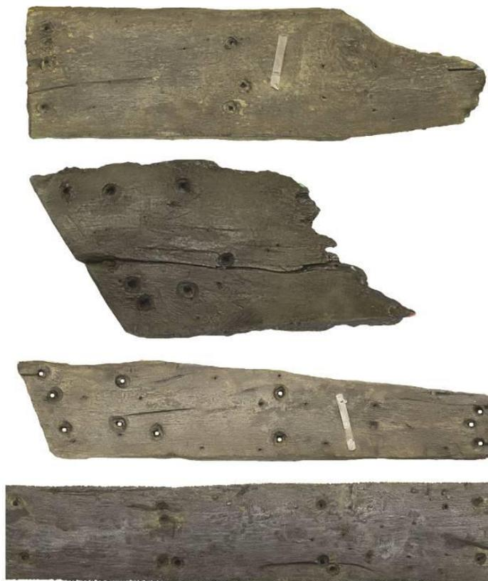
**Figura 124** – Diferentes padrões de fixação da pregadura existente entre as tábuas de forro exterior e o cavename (EDP\_0491, EDP\_0350, EDP\_0287 e EDP\_0202).
