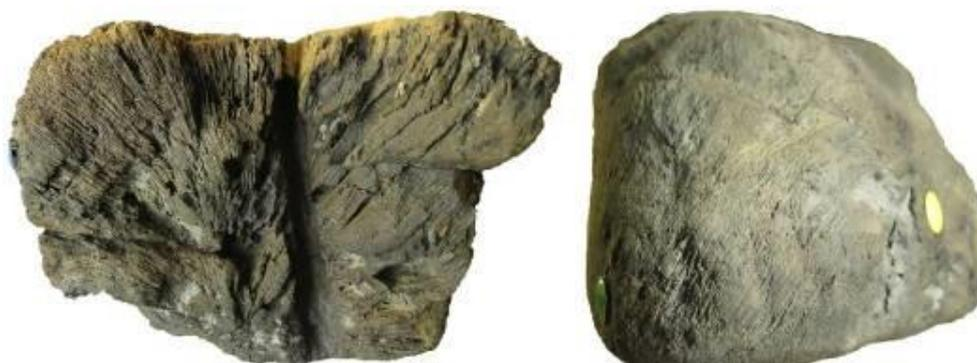
**Figura 226** – EDP\_0062 onde se observa, à esquerda, o corte em meio toro e, à direita, o corte de esquadria em 4.
