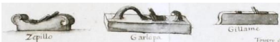
**Figura 211** – Diferentes tipos de plaina (*Álbum de Construcción Naval del Marqués de la Victoria* – (excerto da lâmina 27).
