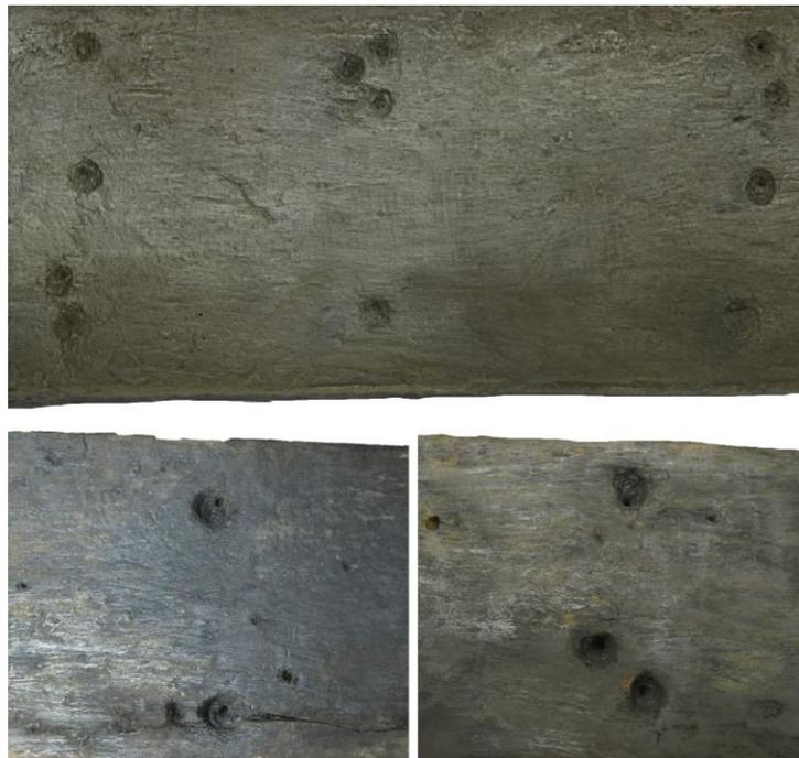
**Figura 139** – Padrão de fixação do forro exterior ao cavername, com a tendência para a colocação dos pregos junto às arestas.
