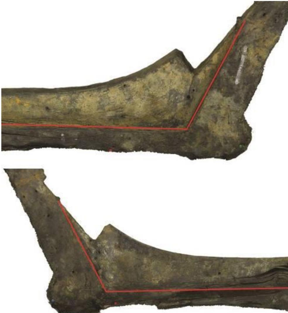
**Figura 86** – Alefrizes registados em ambos os bordos do couce, sendo possível observar a subida em oblíquo em direcção ao cadaste.
