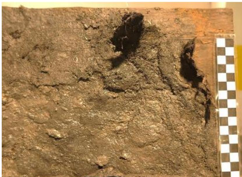
**Figura 155** – Pêlo de cavalo existente entre as tábuas de forro exterior e de sobrecostado EDP\_0584.
