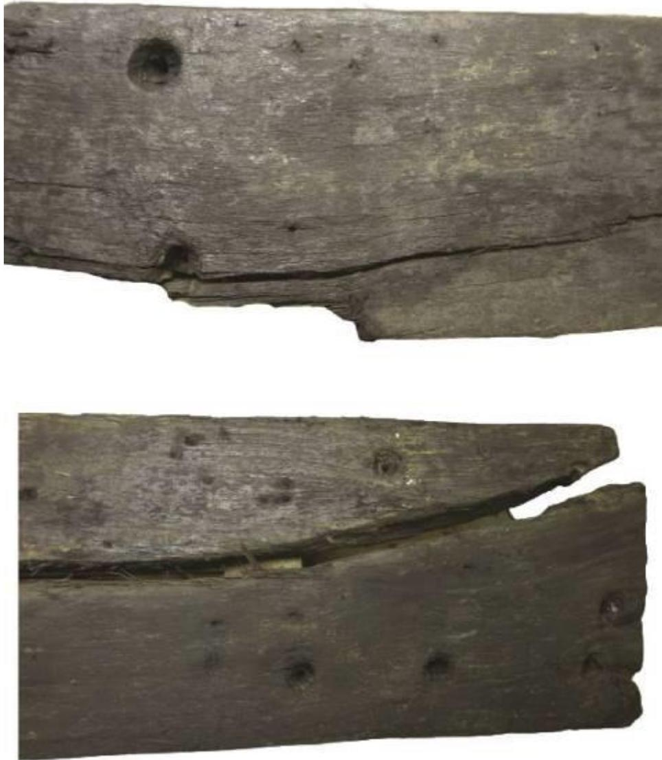
**Figura 147** - Exemplos de tábuas de forro exterior em que se observam os pequenos orifícios correspondentes aos pregos que entravam a partir do sobrecostado e aqui morriam.
