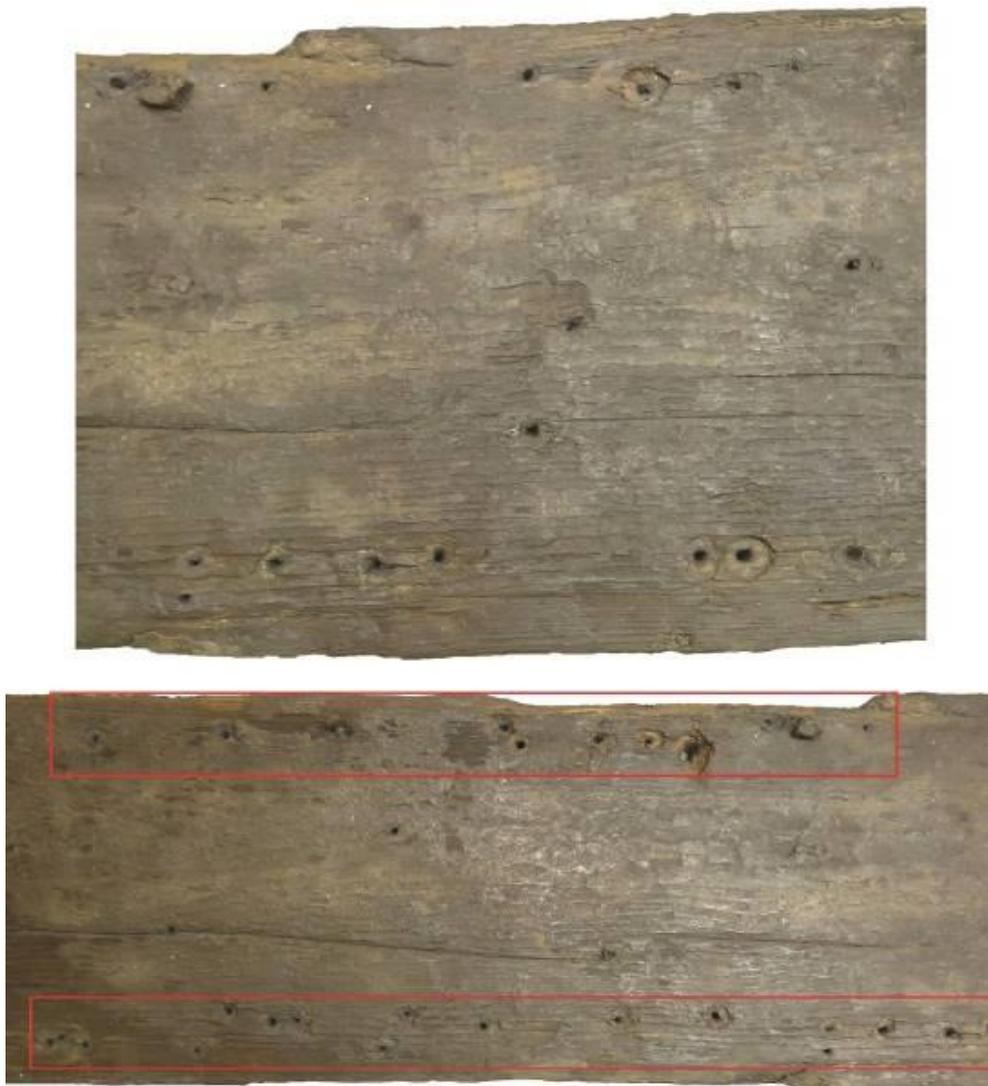
**Figura 146** – Tábua de sobrecostado EDP\_0245 onde se observa claramente a predominância da colocação dos pregos junto às suas arestas, assinalada a vermelho.
