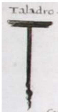
**Figura 213** – Trado (*Álbum de Construcción Naval del Marqués de la Victoria* – (excerto da lâmina 27).
