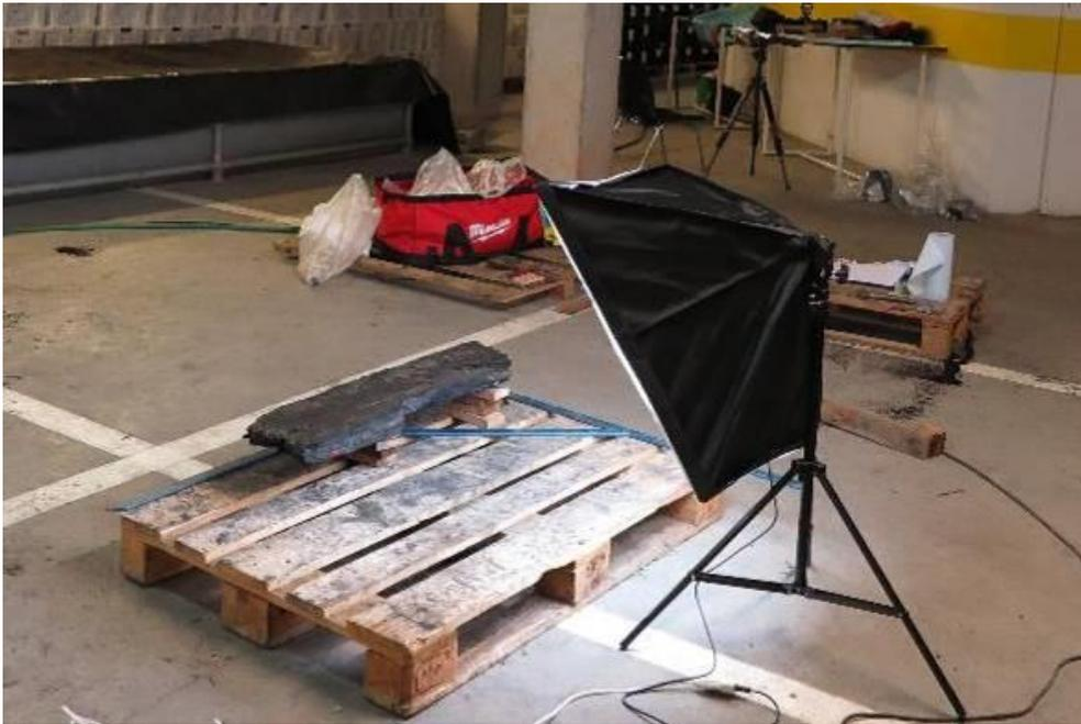
**Figura 11** – Caixas de luz que permitiram o registo fotogramétrico.
