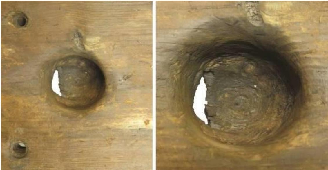
**Figura 183** – Orifício onde trabalhava o eixo do cabrestante, sendo claras as marcas de desgaste.
