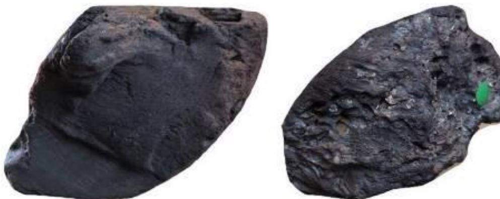
**Figura 234** – EDP\_0153 em que se observa, à esquerda, um corte de esquadria em 4 e, à direita, um corte em toro inteiro, embora o *Teredo navalis* torne difícil a sua observação.
