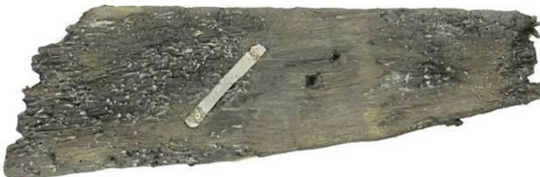
**Figura 24** – Exemplo de uma peça onde se pode observar a forte colonização pelo *Teredo navalis*.
