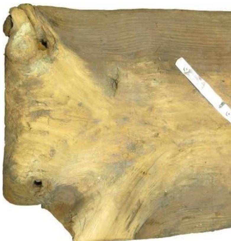
**Figura 180** – Pregos em ferro de secção quadrada com cabeça circular embutida existentes na face superior da peça.
