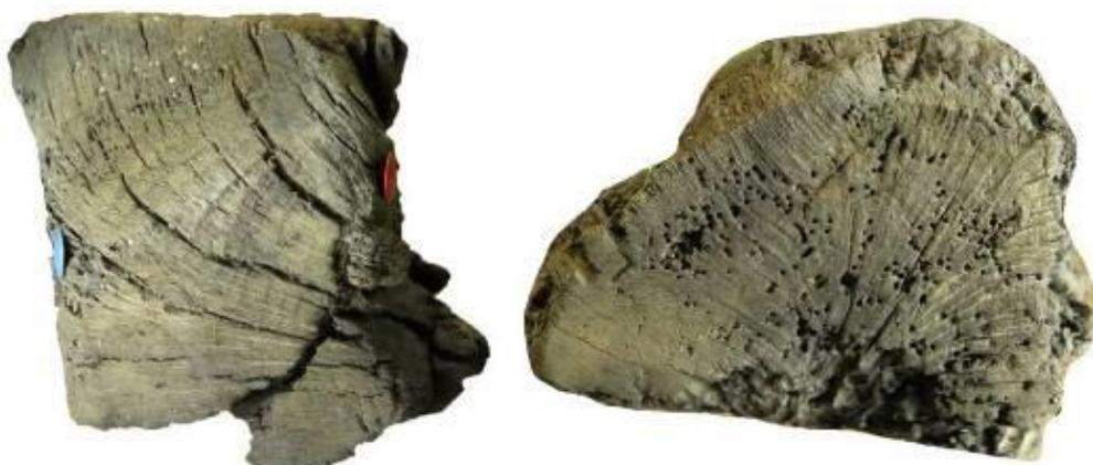
**Figura 229** – EDP\_0378 em que se observa, à esquerda, o corte de esquadria em 4 e, à direita, o corte em toro inteiro.
