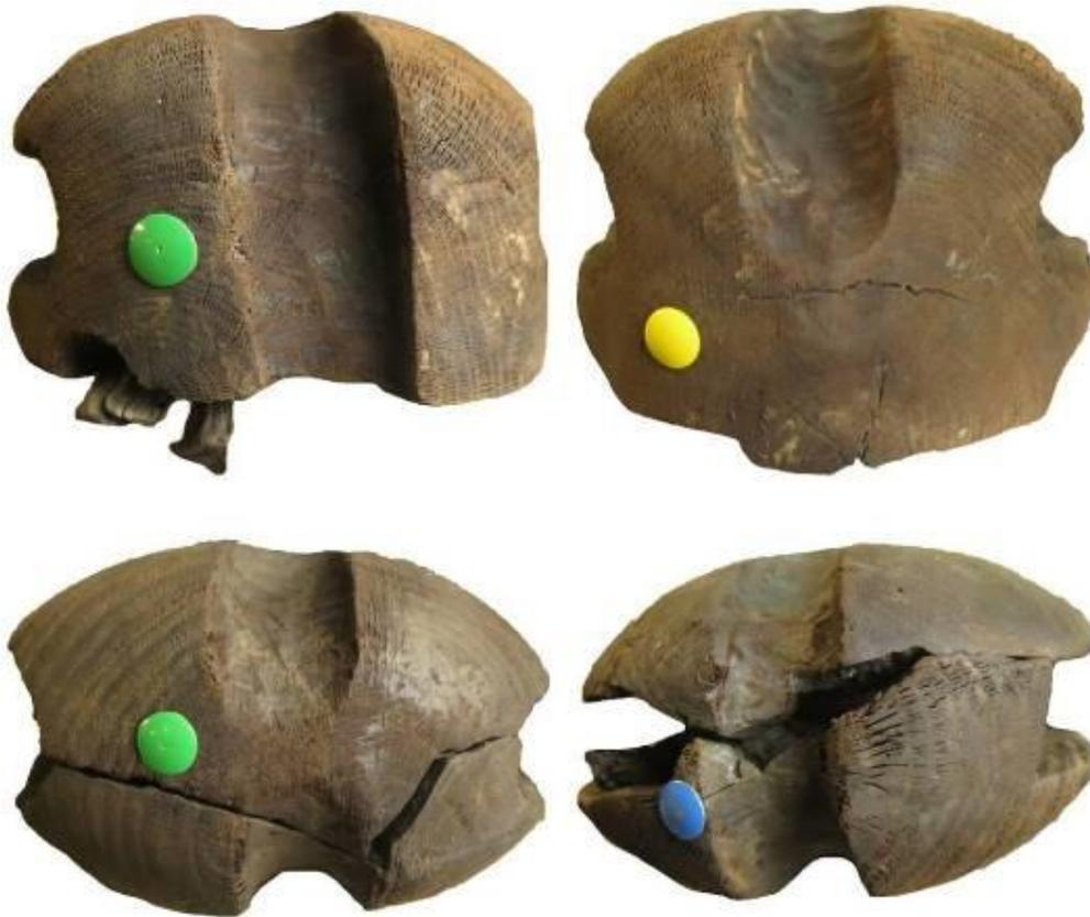
**Figura 245** – Cadernal e moitão grande onde se pode observar a disposição dos anéis que nos indicam a utilização de um toro inteiro.
