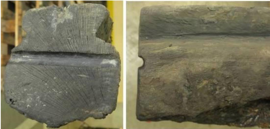
**Figura 72** – Encosto topo a topo existente nas extremidades dos vários talões de quilha.
