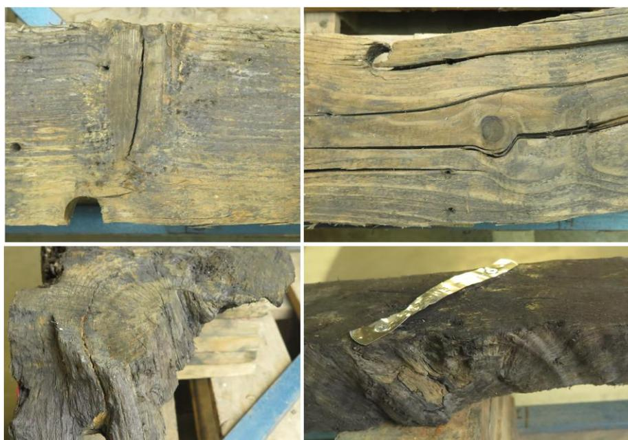
**Figura 223** - Diferentes exemplos das imperfeições e dos nós patentes nas peças náuticas.
