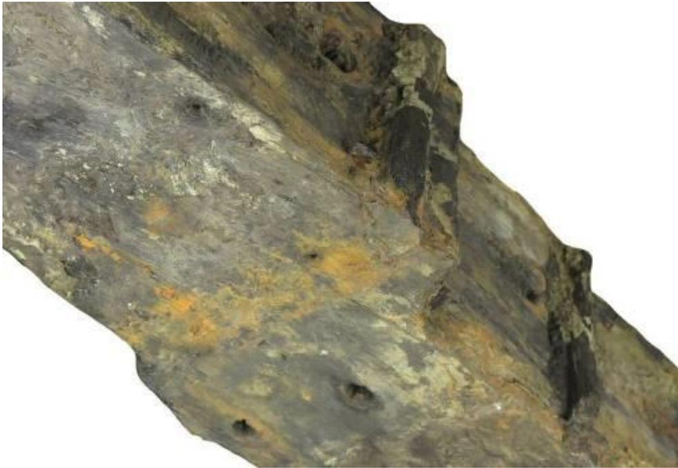
**Figura 87** – Pormenor da face interior do cadaste onde se observam três dos quatro aquastops.
