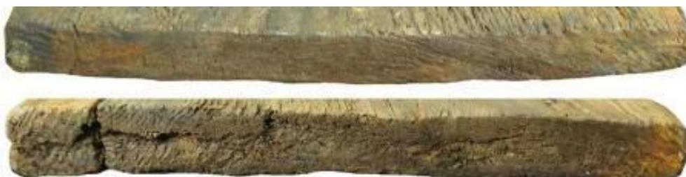
**Figura 241** – EDP\_0247 (tábua de sobrecostado) em que se observa o corte tangencial.
