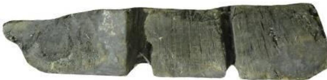
**Figura 240** – EDP\_0093 (tábua de forro exterior) em que se observa o corte tangencial.
