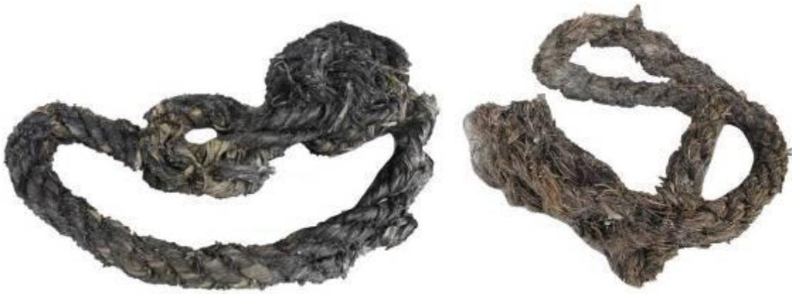
**Figura 168** – À esquerda cabo composto por fibras de cânhamo e à direita cabo feito a partir de fibras de piaçaba. (Foto: José Bettencourt).
