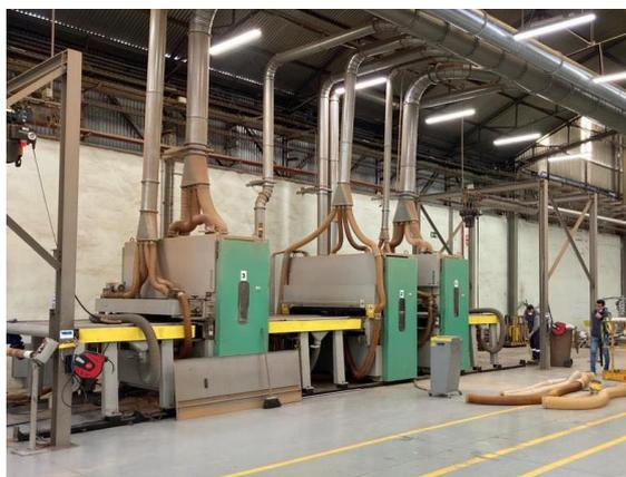
Figura 34 - Secção IV - Processo de lixagem
