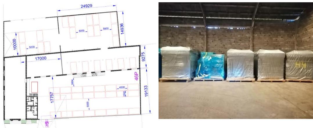
Figura 49 – *Layout* do armazém exterior com a disposição das paletes (à esquerda) e exemplos da paletização utilizada (à direita)
