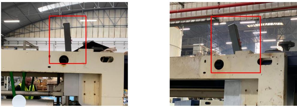
Figura 83 – Estruturas que sofreram de empenos durante o processo de embalamento/transporte
