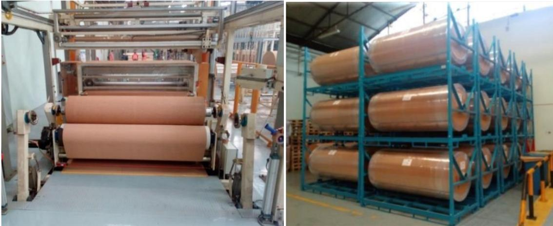
Figura 35 – Processo de rebobinagem (esquerda) e rolos comerciais (direita)
