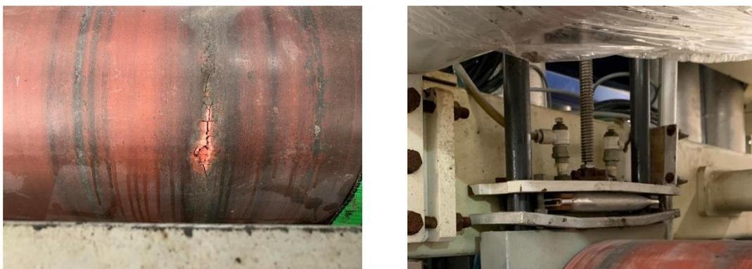
Figura 80 – Estruturas danificadas – rolo (à esquerda) e estrutura de suporte (à direita)
