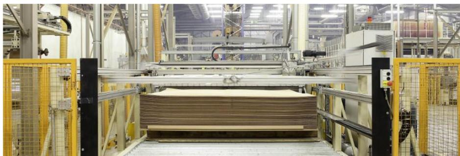
Figura 36 – Sheeter ou processo de corte em placas/folhas
