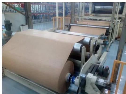
Figura 32 - Sistema de corte (esquerda) e sistema de rebobinagem (direita)
