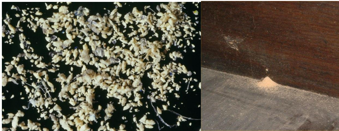
Figura ApE73 – Evidências de atividade da espécie A. punctatum : Resíduos fecais sob ampliação, à esquerda, que apresentam uma forma de grãos de trigo e são pontiagudos quando frescos. À direita, pilha de resíduos por baixo de um orifício de saída, numa madeira infestada (What’s eating your collection, n.d.b & n.d.c).
