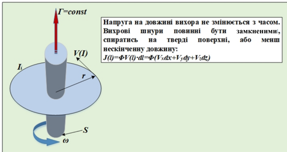
Рис. 4.1.6. Кінематична схема вихору
