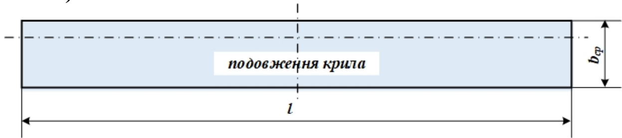
Рис. 7.1.3. Схеми подовження крила
