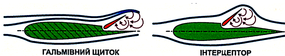
Рис. 7.6.9. Схема гальмівних щитків і інтерцепторів
