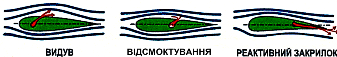
Рис. 5.2.9. Схема керування швидкістю течії в примежовому шарі
