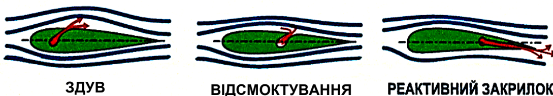
Рис. 7.6.3. Схема здуву і відсмоктування повітря з поверхні профілю
