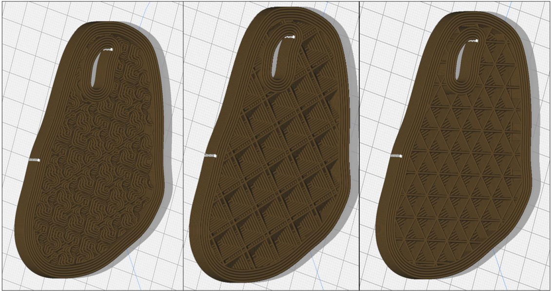
Figura 8 - Exemplo de diferentes tipos de padrões para o infill do objeto com a mesma percentagem (Com o auxílio do software Cura, autoria própria)
