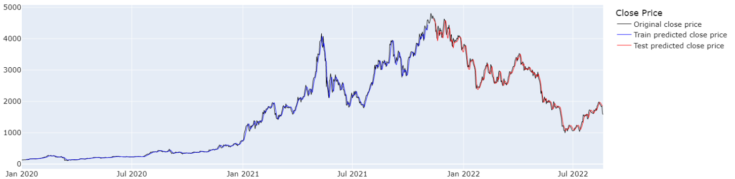
Εικόνα 0-29. Training - Test Results (LSTM 160-85-1) - χωρίς Διαφόριση
