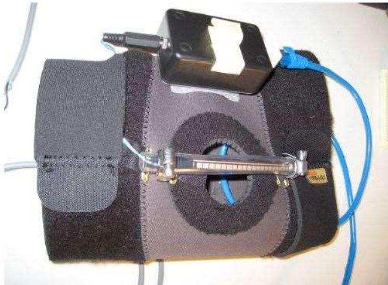
Εικόνα 22: Αισθητήρας τοποθετημένος στο γόνατο του εκτελεστή
