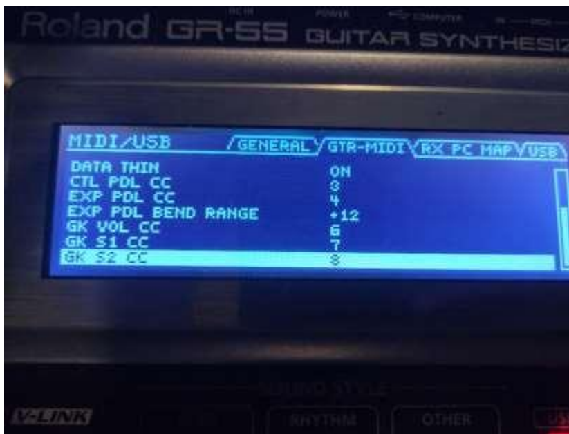
Εικόνα 30: Ρύθμιση midi στοιχείων στην πεταλιέρα GR-55
