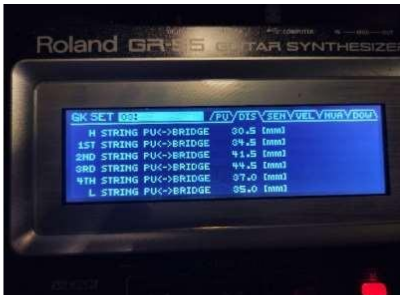
Εικόνα 11 Παράρτημα 2: Το ύψος της κάθε χορδής από τον μαγνήτη μετρημένο σε mm
