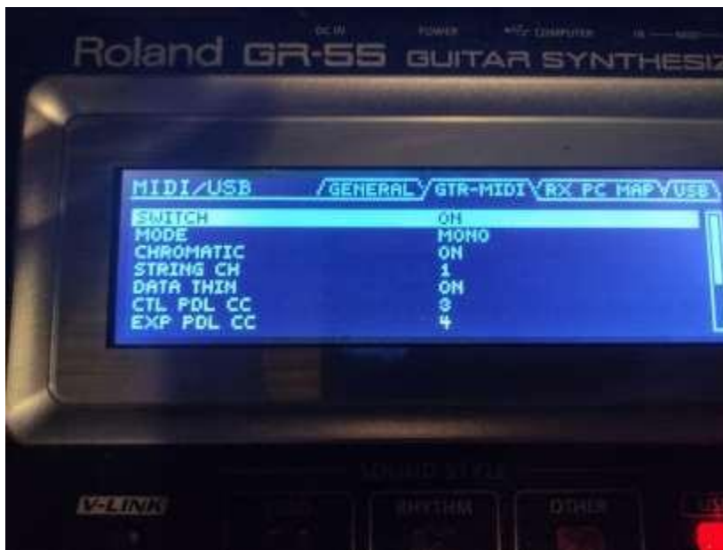
Εικόνα 29: Ρύθμιση midi στοιχείων στην πεταλιέρα GR-55
