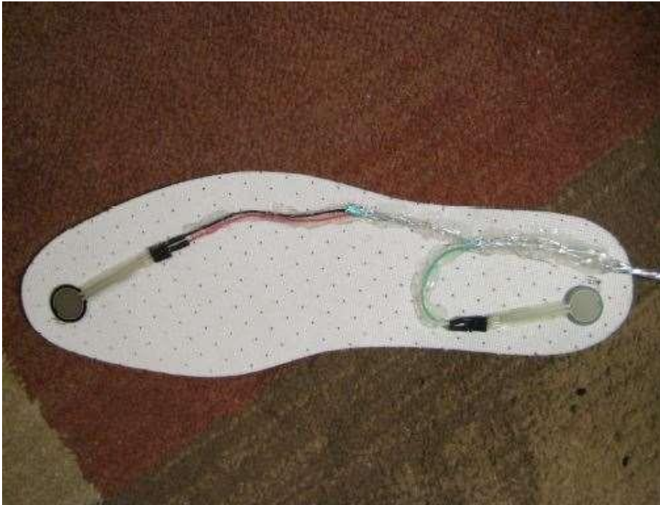
Εικόνα 1 Παράρτημα 1: Αισθητήρας τοποθετημένος στο πόδι (μέσα στο παπούτσι) του εκτελεστή
