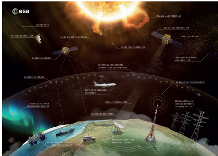
Σχήμα 1.21: Η επίδραση του Διαστημικού Καιρού στο γεωδιάστημα. Credit: European Space Agency / Science Office, CC BY-SA 3.0 IGO
