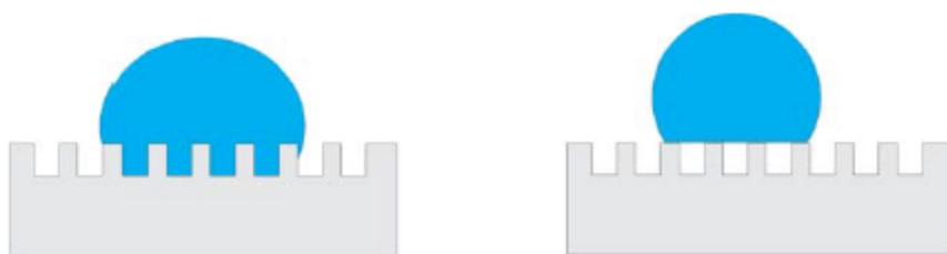
Εικόνα 5: Συμπεριφορά σταγόνας σε τραχιά επιφάνεια. Αριστερά, το υγρό εισδύει μέσα στις αιχμές (κατάσταση Wenzel) και δεξιά, το υγρό αιωρείται πάνω στις αιχμές (κατάσταση Cassie-Baxter) 15
