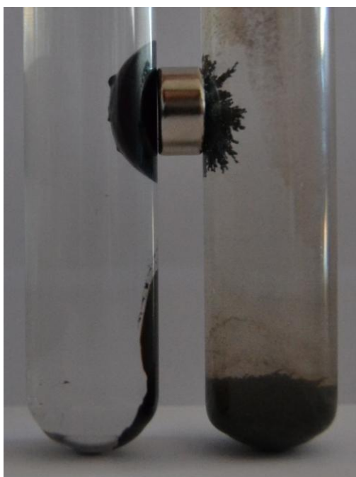
Εικόνα 11: Μαγνήτης επιδρά σε ferrofluid και σε ρινίσματα σιδήρου
