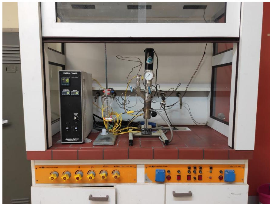
Εικόνα 24: Ο αντιδραστήρας μικρού μεγέθους με τον πύργο ελέγχου μέσα στον απαγωγό.
