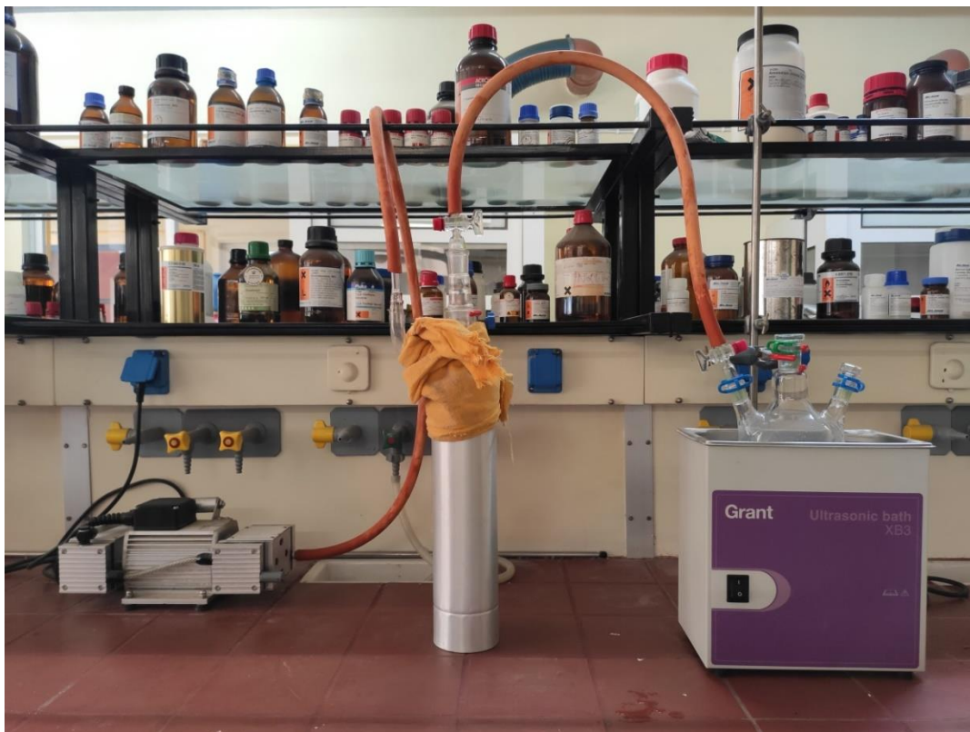
Εικόνα 27: Διάταξη για παρασκευή απαερωμένου νερού.
