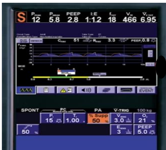
Εικόνα 5. Monitor αναπνευστήρα στο οποίο καταγράφεται ο αυτόματος υπολογισμός της πίεσης που πρέπει να ασκηθεί σε κάθε εισπνευστική προσπάθεια
