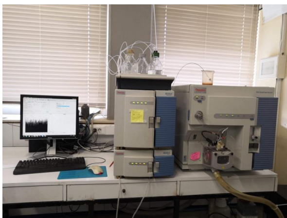
Εικόνα 29. Υγροχρωματογραφικό σύστημα με ανιχνευτή φασματομετρίας μαζών με τριπλό τετράπολο (LC-MS/MS) της Thermo Scientific Quantum.
