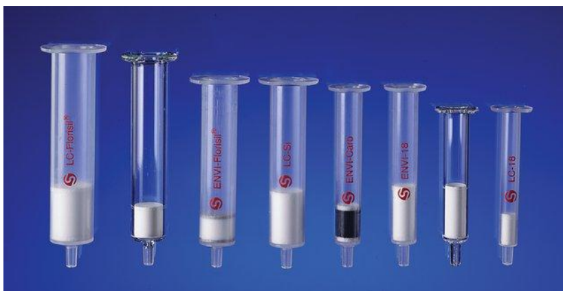
Εικόνα 13. Στηλάκια με διαφορετικά στερεά υποστρώματα που χρησιμοποιούνται στην εκχύλιση στερεάς φάσης. (93)
