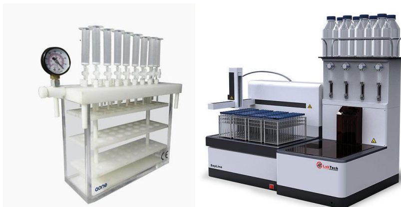
Εικόνα 15. Συσκευή εκχύλισης στερεάς φάσης με κενό (αριστερά) και αυτόματη συσκευή εκχύλισης στερεάς φάσης (δεξιά). (95), (96)
