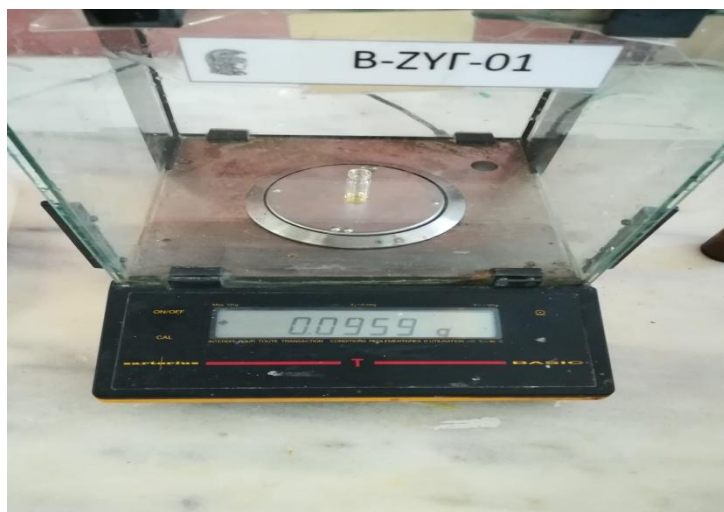
Εικόνα 32. Διακριβωμένος αναλυτικός ζυγός τεσσάρων δεκαδικών ψηφίων.
