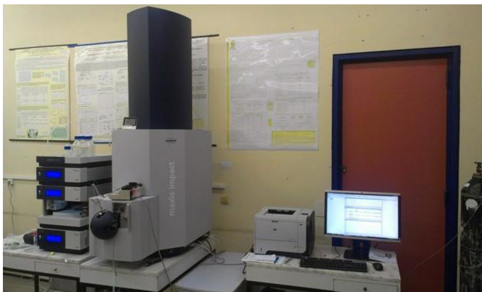
Εικόνα 30. Σύστημα υγροχρωματογραφίας συζευγμένο με φασματομετρία μαζών υψηλής διακριτικής ικανότητας τετραπόλου-αναλυτή χρόνου πτήσης (Q-ToF).
