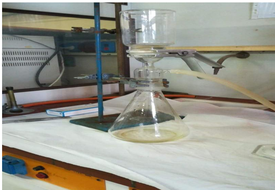
Εικόνα 31. Συσκευή διήθησης διαλυτών κινητής φάσης και δειγμάτων.
