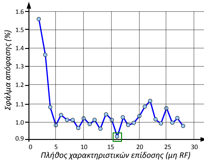
Σχήμα 7.3: Σχέση σφάλματος απόφασης αποδοχής/απόρριψης (pass/fail) και πλήθους ‘μη RF’ χαρακτηριστικών επίδοσης τα οποία χρησιμοποιούνται για τη λήψη της απόφασης [167]
