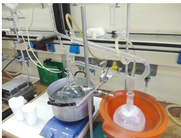
Εικόνα 64: Πειραματική διάταξη σχηματισμού νανοσωματιδίων και κυκλικών σε διαλύτη διβενζυλαιθέρα σε θερμοκρασία 250 °C και αποστακτική συσκευή διαλυτών πολύ υψηλού σημείου ζέσεως (Home made).
