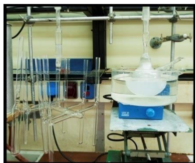
Εικόνα 55: Βαθμονομημένες αμπούλες για απόσταξη στυρενίου.
