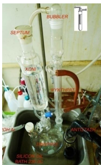
Εικόνα 64: Πειραματική διάταξη σχηματισμού νανοσωματιδίων και κυκλικών σε διαλύτη διβενζυλαιθέρα σε θερμοκρασία 250 °C και αποστακτική συσκευή διαλυτών πολύ υψηλού σημείου ζέσεως (Home made).
