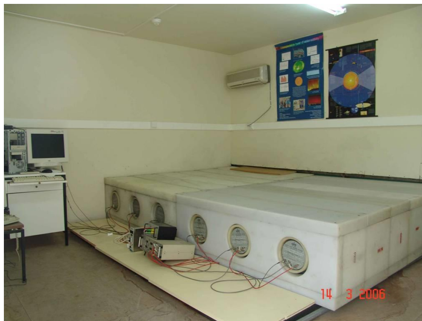
Σχήμα 2.7 Ο μετρητής Νετρονίων του Πανεπιστημίου Αθηνών λειτουργεί με τεχνολογία πραγματικού χρόνου ανεληπώς από το Νοέμβριο του 2000 (τέταρτος κατά σειρά παγκοσμίως) (A.Ne.Mo.S.)
