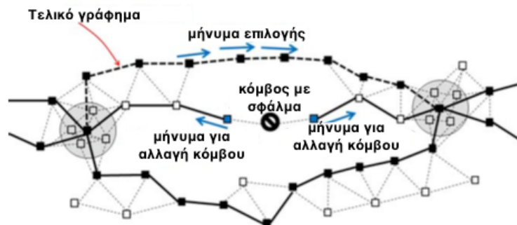
Εικόνα 57: Αποκατάσταση σφάλματος στη ζώνη φράγματος
