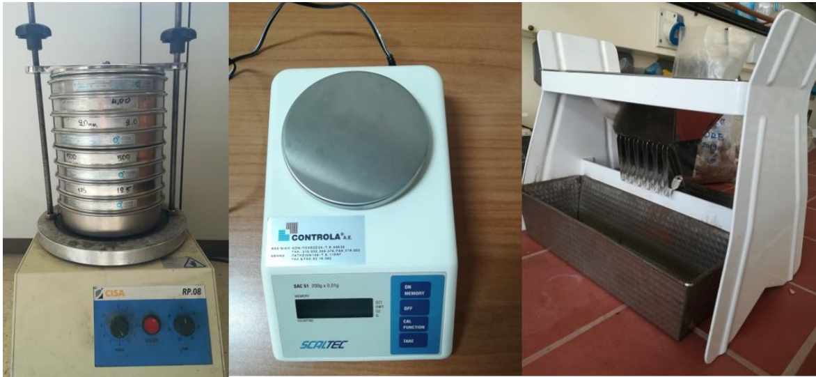
Εικόνα 23 Εξοπλισμός κοκκομετρικής ανάλυσης ιζημάτων
