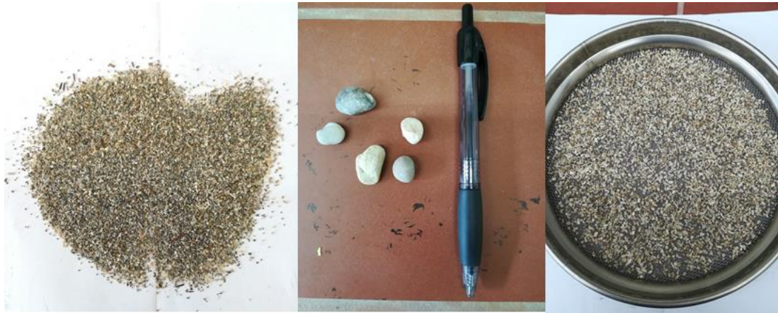
Εικόνα 24 Ίζημα που κατακρατήθηκε στα κόσκινα
